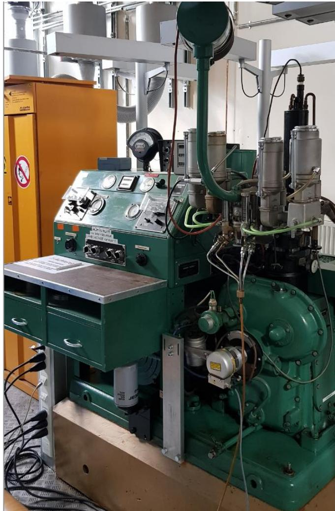
Abbildung 5.1: ASTM-CFR Sonderottomotor
