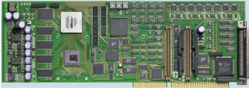
Abbildung 7.2: DS1103 PPC Controller Board [23]
