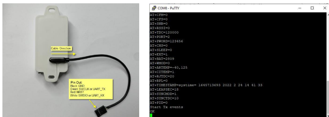
Abbildung 29a und 29b: TTL-Pinbelegung des Programmierkabels [30] 15 sowie PuTTY-Screenshot während Sensorkommunikation
