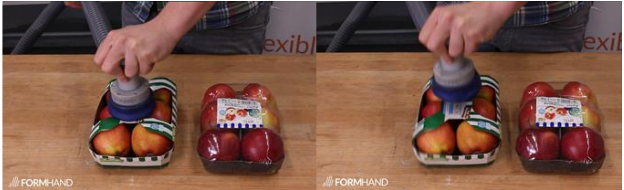
Abbildung 33: Greifversuch 1 mit kleinem Formhandgreifer [29]
