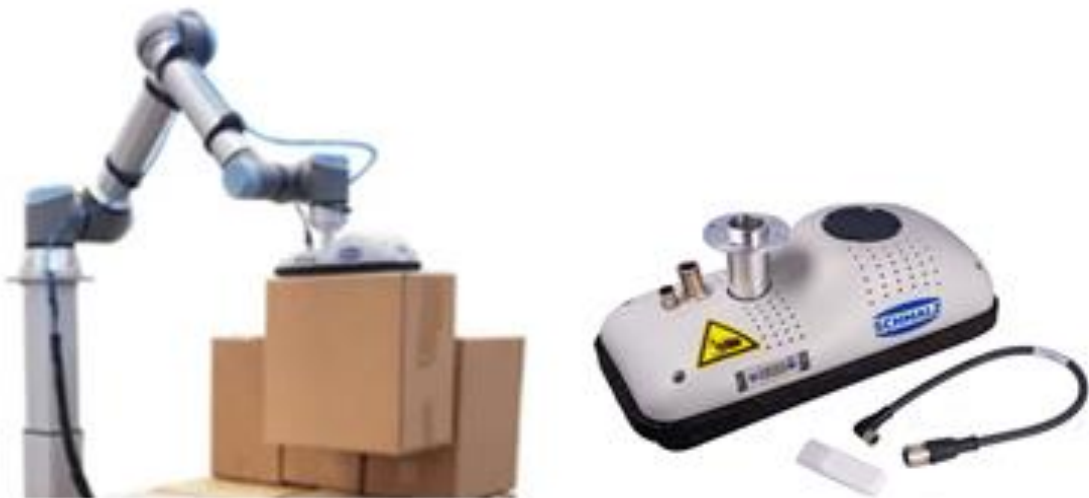
Abbildung 8: Vakuum Greifer - ROB-SET FXCB UR O20 [8]
