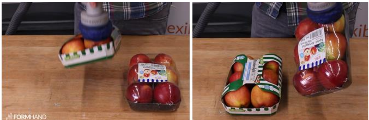
Abbildung 34: Greifversuch 2 Formhandgreifer FH-R80 [29]
