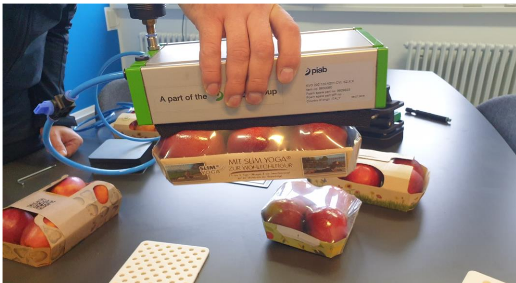
Abbildung 25: Greifversuch mit Vakuumgreifer KVG Teil 2 – Folienfoodtainer
