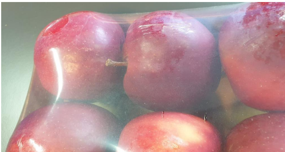
Abbildung 29: Rückstellung der Folie und Rissbildung
