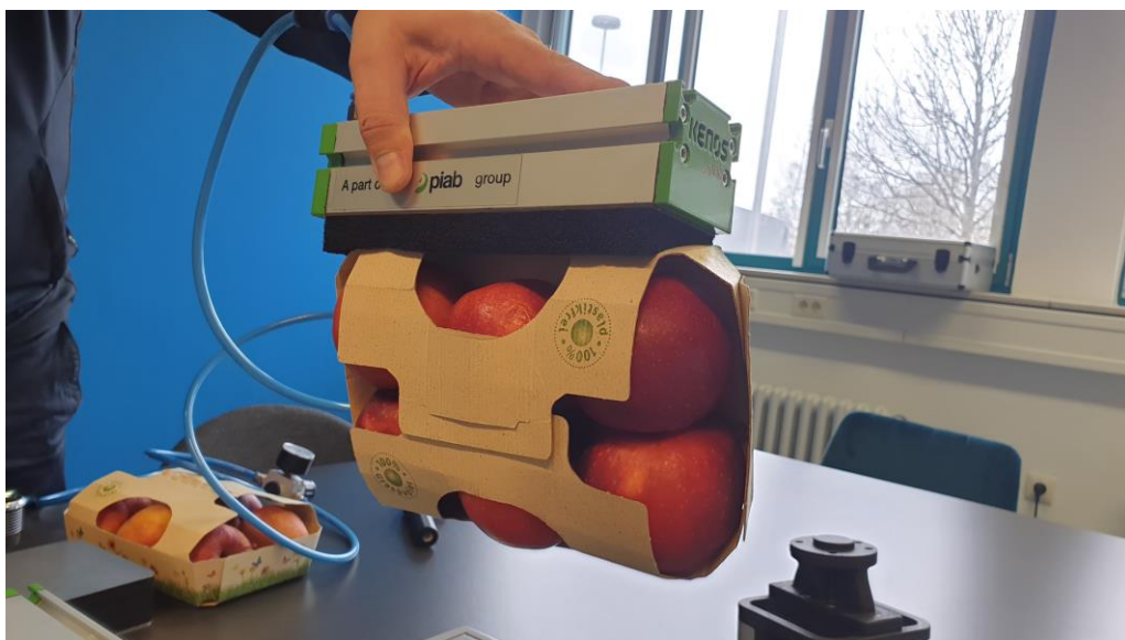
Abbildung 27: Hochkant Greifversuch mit Vakuumgreifer KVG 60 – Blitzfoodtainer
