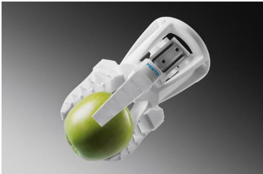
Abbildung 12: Bionische Greifer DHDG - Fin Ray Effekt [17]
