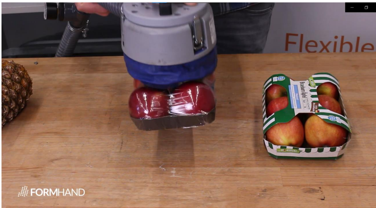
Abbildung 31: Greifversuch mit Formhandgreifer FH-R150 – Folienfoodtainer [29]
