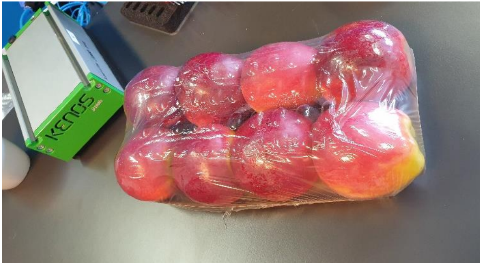
Abbildung 28: Verformung der Folie
