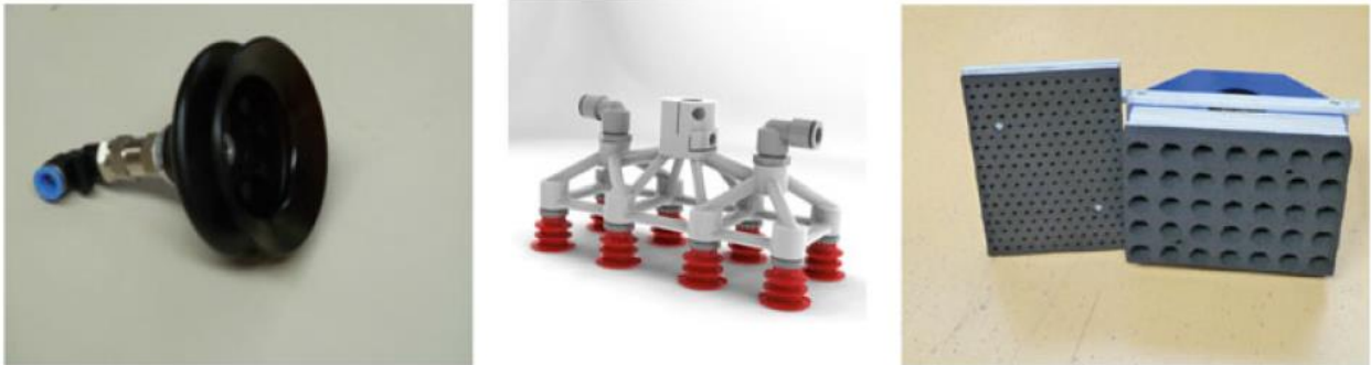
Abbildung 7: Auswahl von typischen Sauggreifern – Saugelemente [5]
