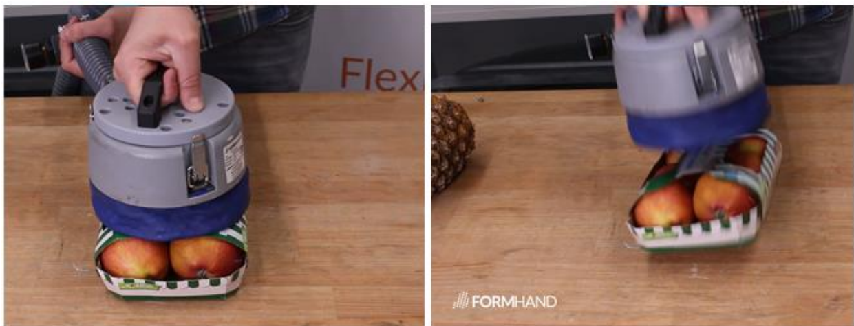
Abbildung 32: Greifversuch mit Formhandgreifer FH-R150 – Blitzfoodtainer [29]
