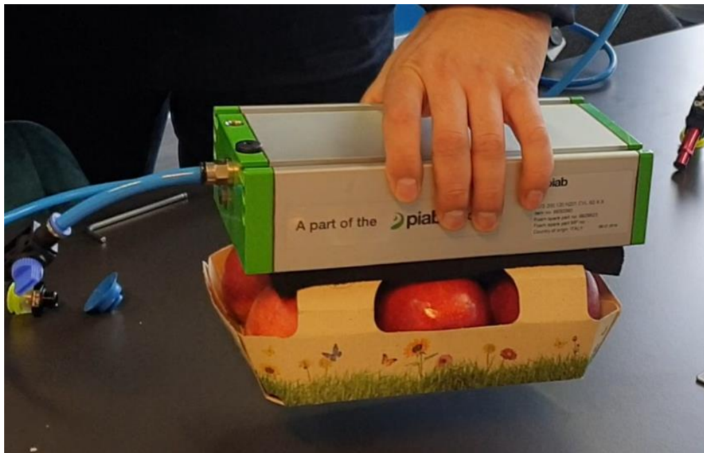
Abbildung 26: Greifversuch mit Vakuumgreifer KVG Teil 3 – Blitzfoodtainer
