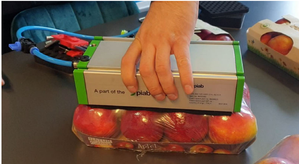
Abbildung 24: Greifversuch mit Vakuumgreifer KVG Teil 1 – Folienfoodtainer
