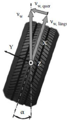
Abbildung 2.6: Schräglaufwinkel am Reifen[4]
