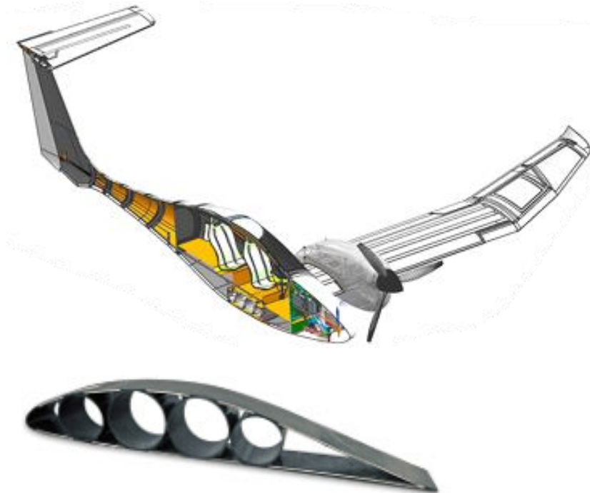
Abbildung 15: Die Gesamtinnenstruktur und das Wasserstoffflügeldesign des APUS i-2-Flugzeugs (APUS Zero Emission)
