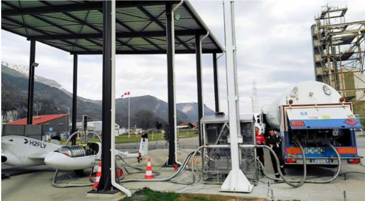
Abbildung 6: Betankungstest des Demonstrationsflugzeugs mit flüssigem Wasserstoff (Lienerth, 2023)
