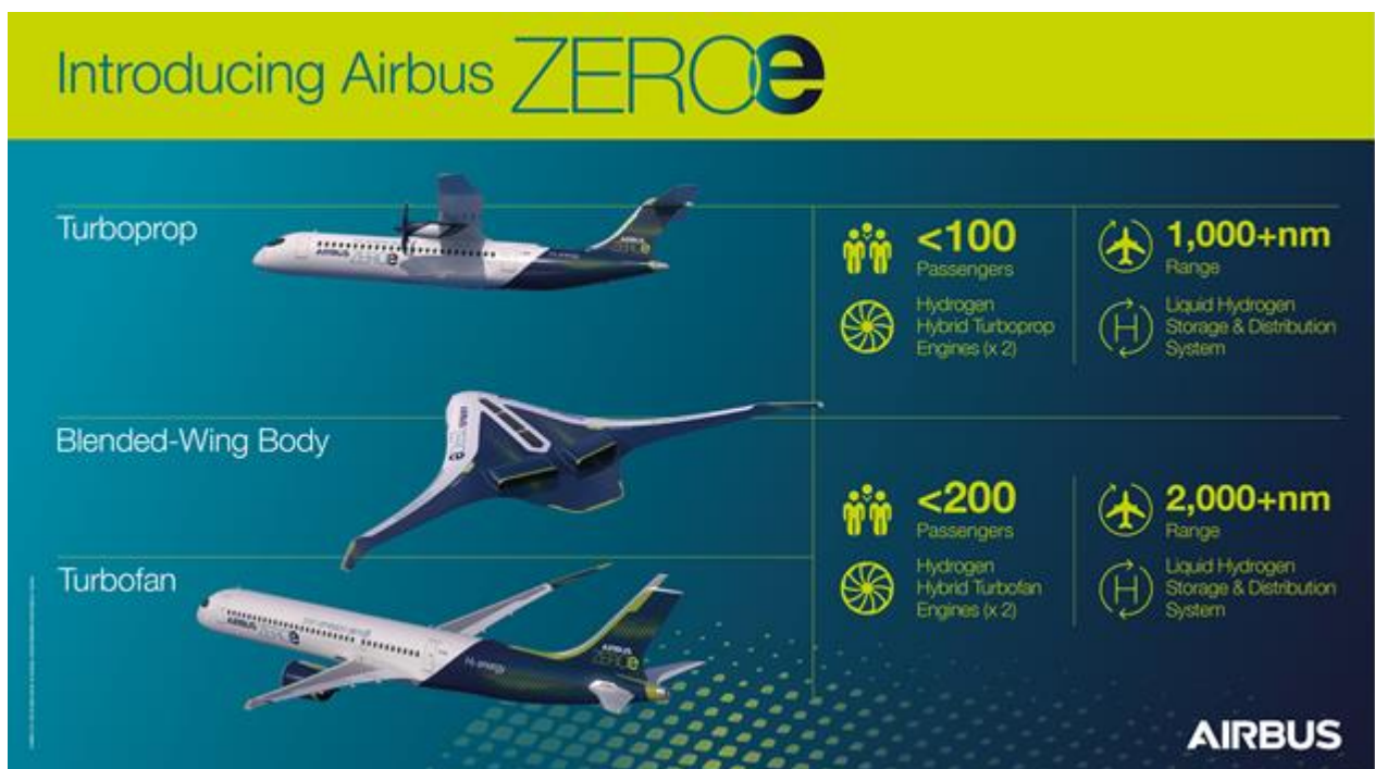
Abbildung 5: ZEROe-Konzeptflugzeug mit den drei möglichen Konfigurationen (Tasic et al., 2021)
