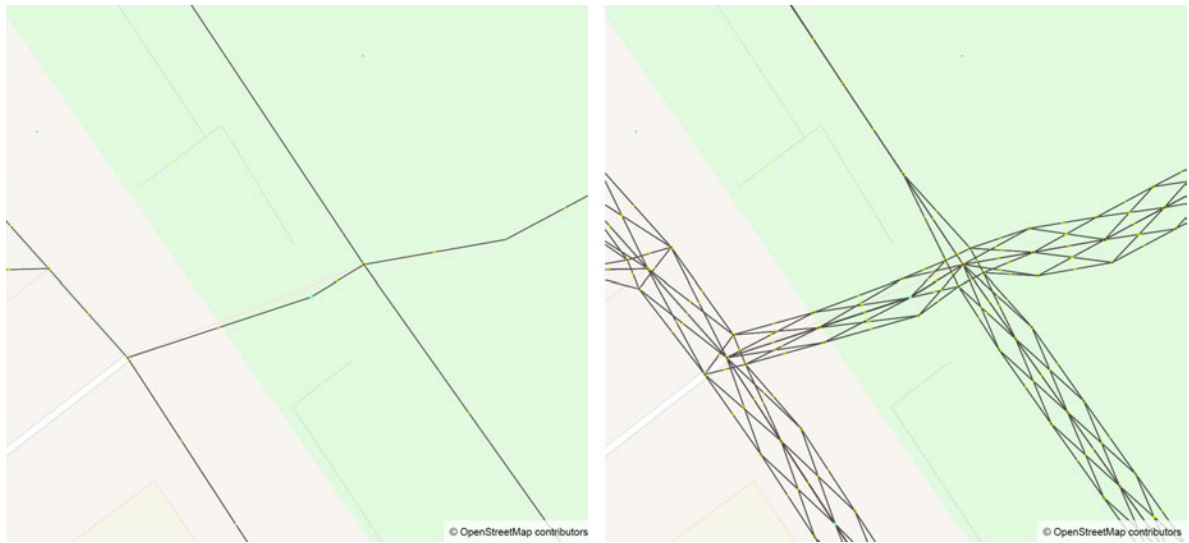
Abbildung 9.2: Links: Navigationsdaten vor der Vernetzung, rechts: Daten nach der Vernetzung (Quelle: [42], eigene Darstellung)
