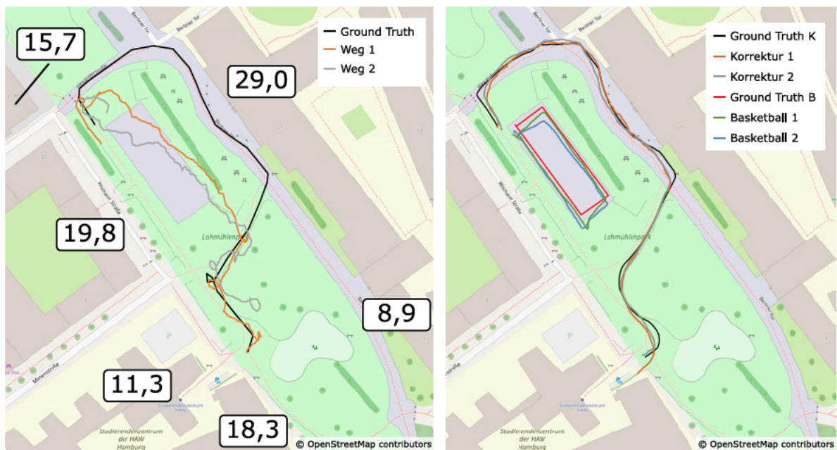
Abbildung 8.2: Links: GPS-Position ohne Korrektur, rechts: GPS-Position mit korrigierter Position (Quelle: [42], eigene Darstellung)
