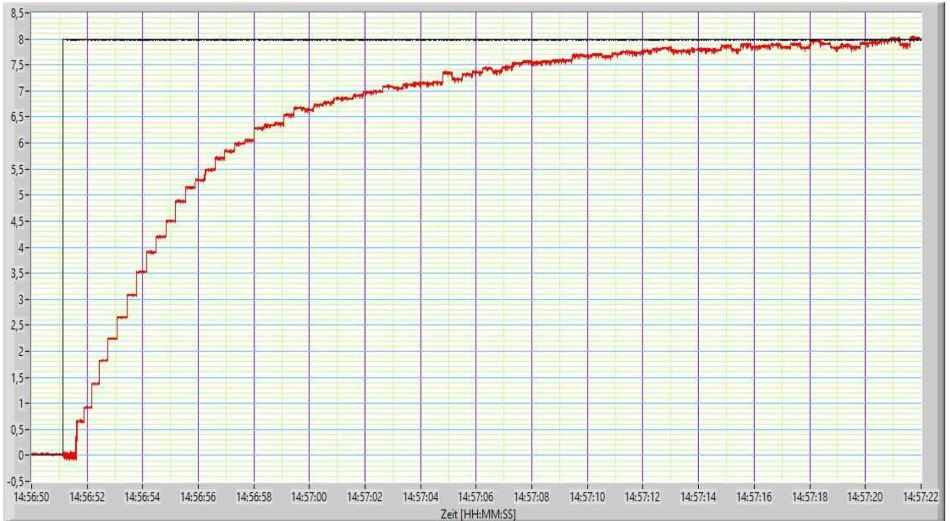
VERSUCH : Schwungscheibe3,12s mit Drehzahlsteller
