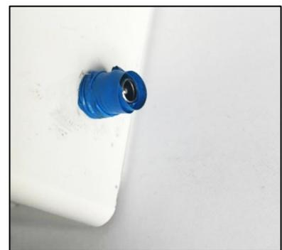
Abbildung 11: Netzteilbuchse
