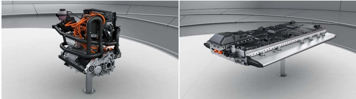
Abbildung 5: Elektromotor und HV-Batterie Quelle [20]
