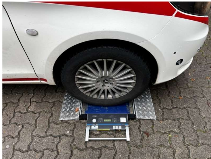
Abbildung 10: e-NEF auf Fahrzeugwaage
