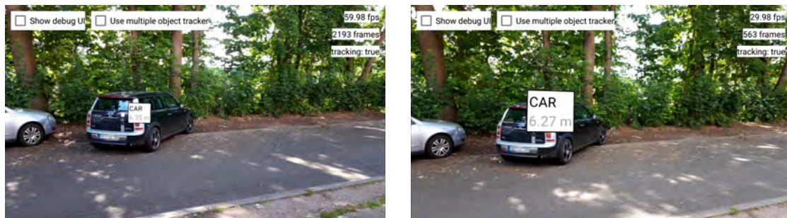
Abbildung 5.5: Platzierung des Schildes mit der selben Entfernung des etwa sechseinhalb Meter entfernten Objekts (links) und mit festem Abstand von drei Metern (rechts)
