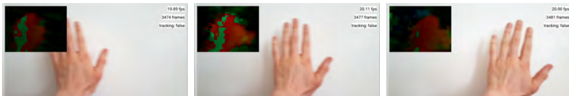
Abbildung 4.3: Bildsequenz mit dichtem Optischem Fluss dargestellt durch Verfärbung der bewegten Pixel
