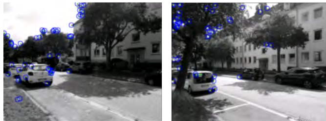
Abbildung 4.4: Extrahierte Merkmale für spärlichen optischen Fluss
