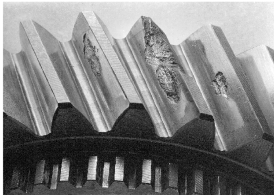
Abbildung 4.31.: Grübchenbildung mit Zahnkopfbuch infolge von Flankenermüdung [13, S.241]
