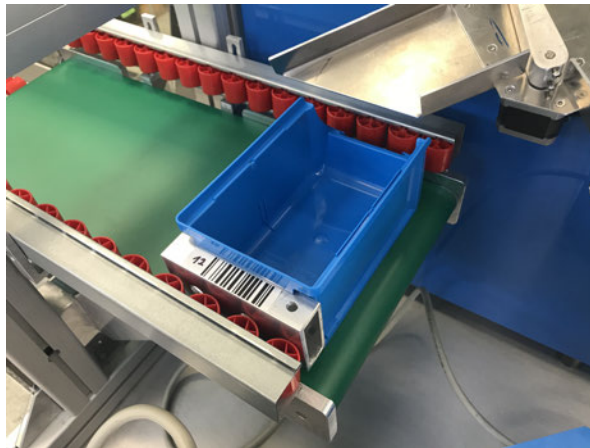
Abbildung 3.3.: Abgabeförderband mit Stichprobenkasten
