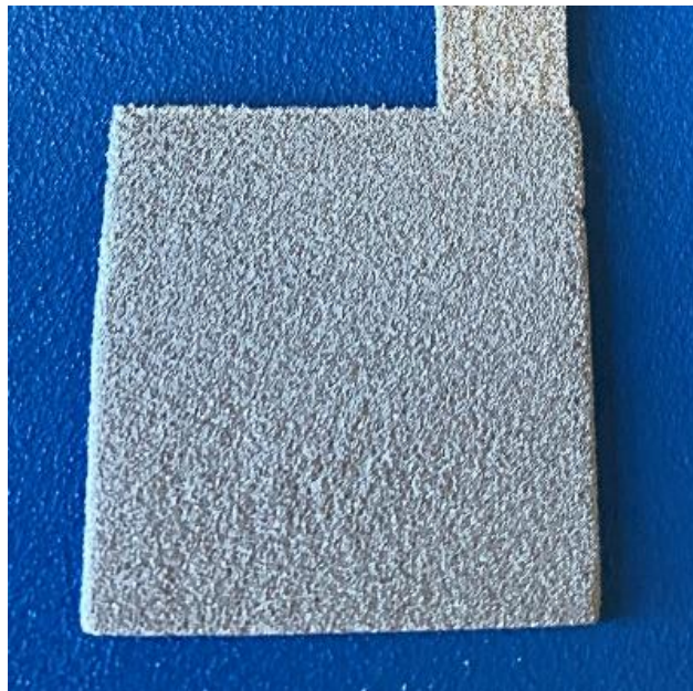
Abbildung 4: Titanfilz für die Diffusionsschicht in PEMEC-Anode
