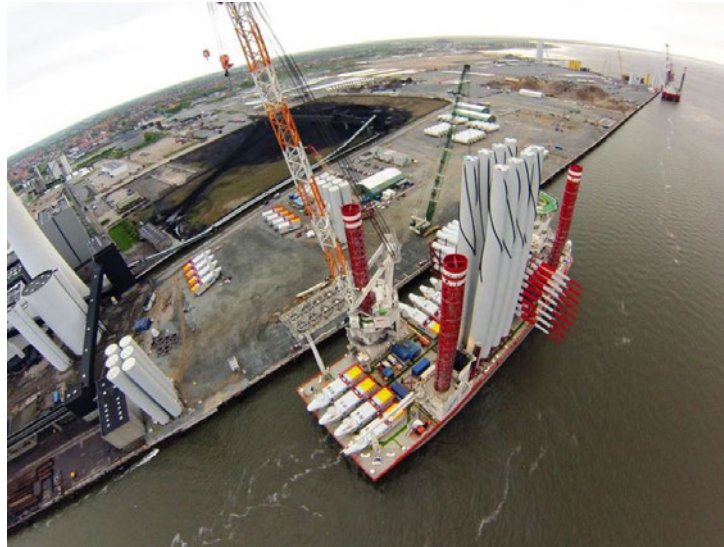
Abbildung 3.2: Windenergieanlagenkomponenten beim Umschlag auf die BRAVE TERN im Hafen von ESBJERG [48]
