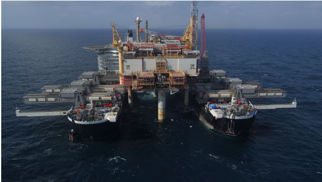
Abbildung 3.6: PIONEERING SPIRIT vor dem Anheben eines Plattformoberteils im YMES Ölfeld 2016 [1]
