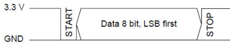
Abbildung 4.2: UART-Rahmenformat der ToF-Kamera [14]
