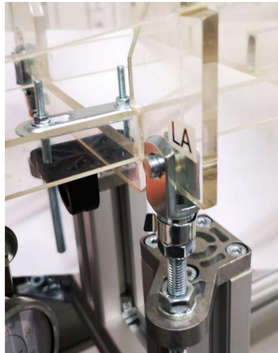
Abbildung 37 – Eingesetzter Sicherungsbolzen am Gabelkopf an der Vorderachse
