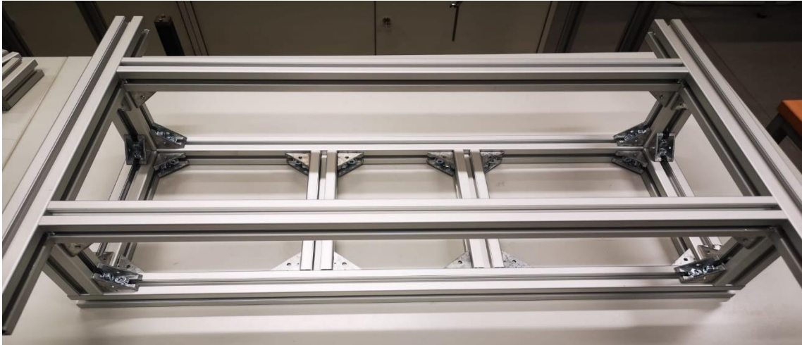
Abbildung 25 – Basiselement des Versuchsprüfstands
