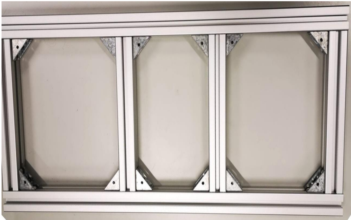
Abbildung 22 – Rahmen der Grundkonstruktion
