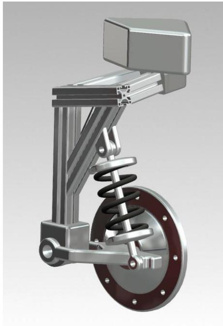
Abbildung 7: Konzeptionierung eines Radelements des bisherigen Konzepts [GRB21-1]
