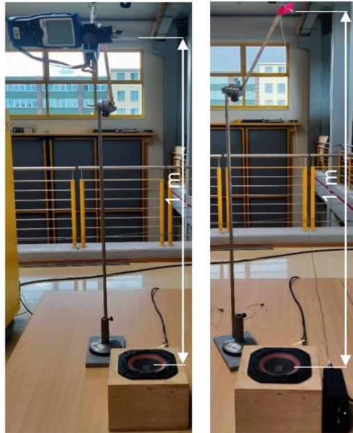
Abbildung 5-5: Messaufbau für die Kalibrierung der Messmikrofone
