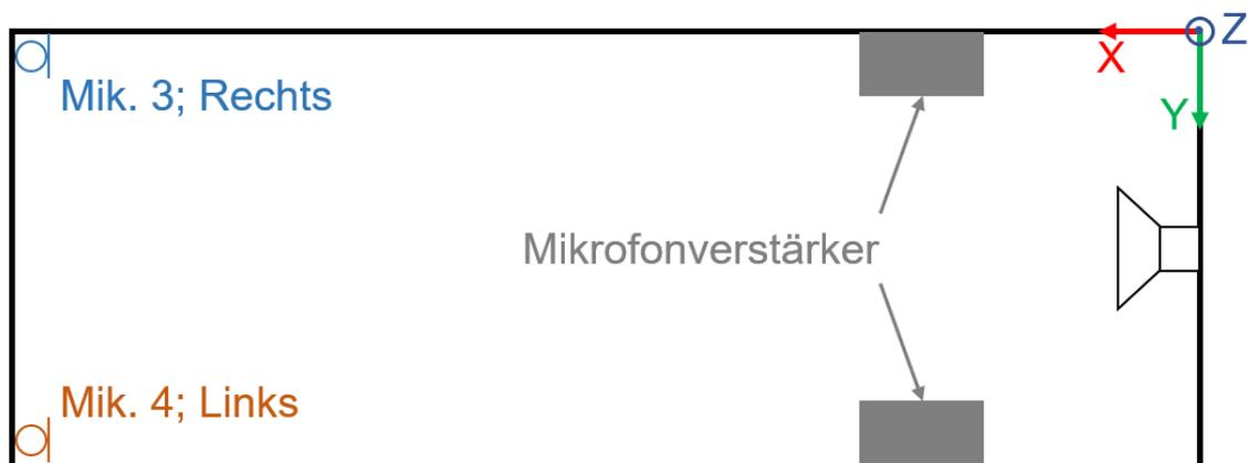
Abbildung 5-1: Position der Messmikrofone, des Lautsprechers und der Mikrofonverstärker für die Messung der Frequenzantwort
