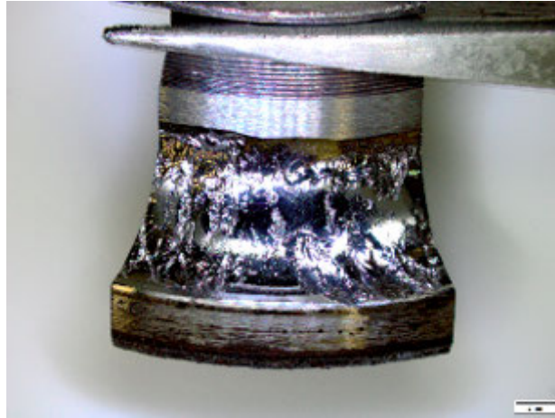
Abbildung 2.15.: Oberflächenzerrüttung am Innenring eines Wälzlagers [40].
