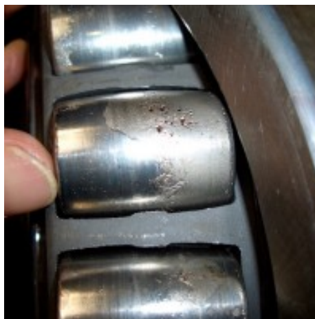
Abbildung 2.14.: Adhäsiver Verschleiß an Wälzkörpern [45].
