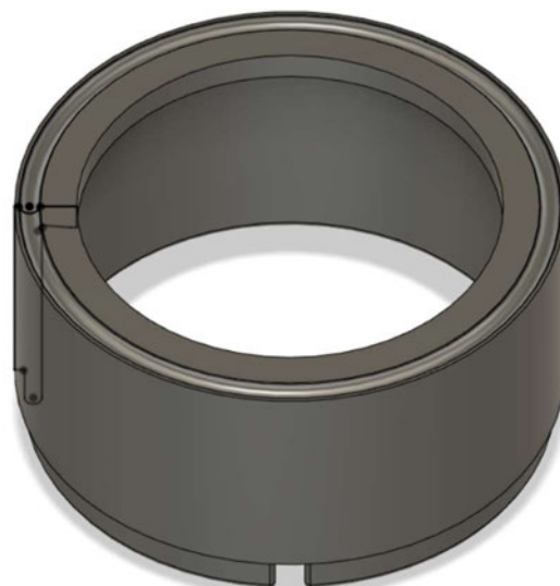
Abbildung 34: Gehäuseoberteil mit Profilskizze
