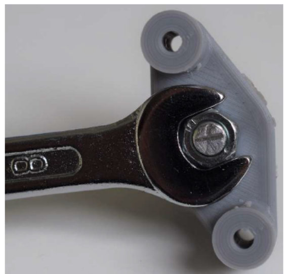
Abbildung 81: Prüflingsanbindung 30 mm mit Montagewerkzeug
