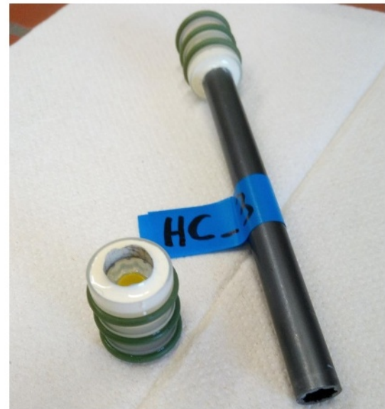
Abbildung 26: Kopfzelle HC3 nach Beschädigung
