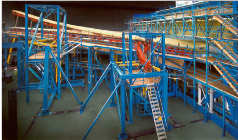
Abbildung 7: Ermüdungsversuch an der Flugzeugstruktur [Mensen 2013]
