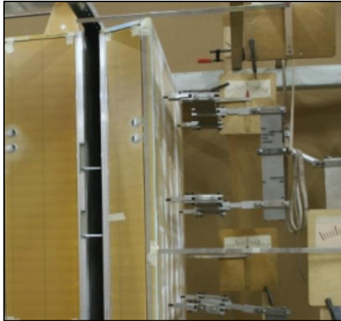
Abbildung 9: Quasistatische Tests an einem Kabinenmodul [Lampen 2014]
