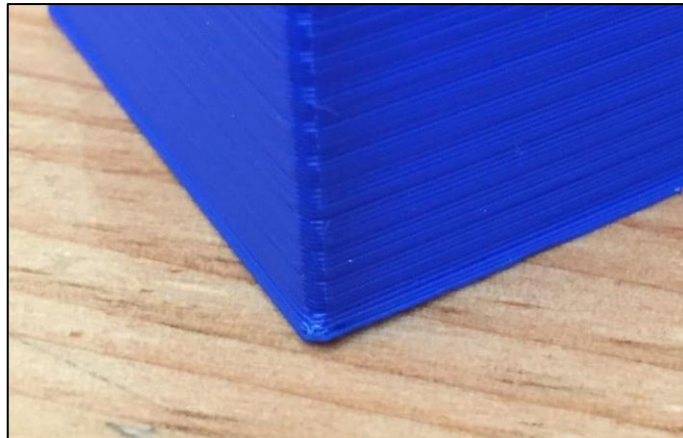
Abbildung 24: Elefantenfuß am 3D-Druckbauteil [AB3D 2021]
