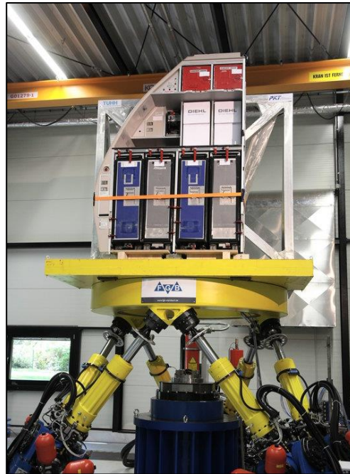
Abbildung 8: Anbindung einer Bordküche an einem Hexapod-System [TUHH 2012]
