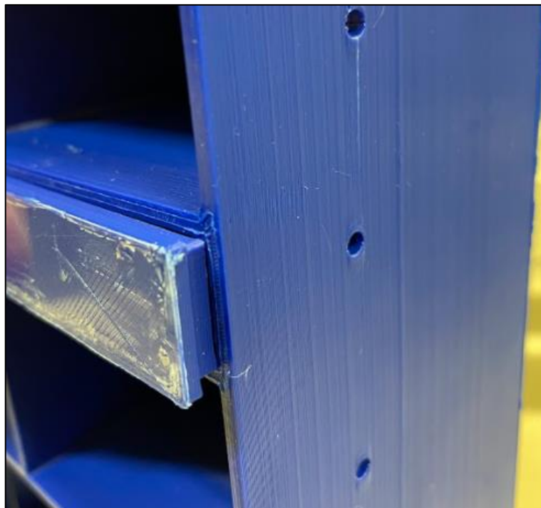
Abbildung 73: Fehlende Passgenauigkeit des Druckelementes
