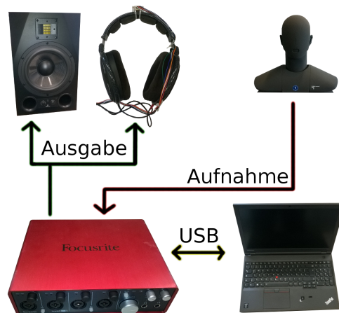
Abbildung 6.8: Logische Verbindungen der eingesetzten Messgeräte
