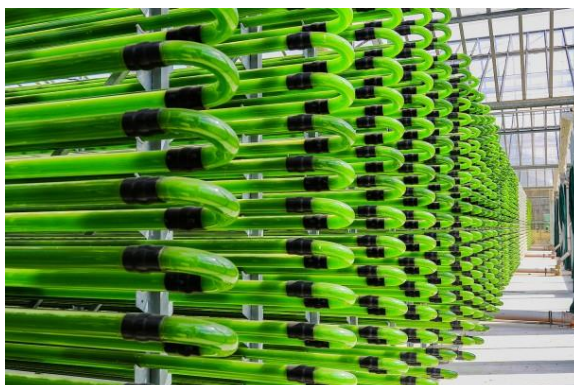
Abb. 6: Lichtkollektor eines Rohrreaktors der Firma Roquette Klötze GmbH & Co. KG[34]
