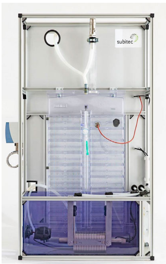
Abb. 17: Plattenreaktor der Firma Subitec GmbH[32]
