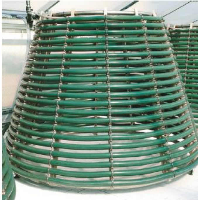
Abb. 7: Lichtkollektor eines Tannenbaum-Rohrreaktors der Firma Gicon[5]
