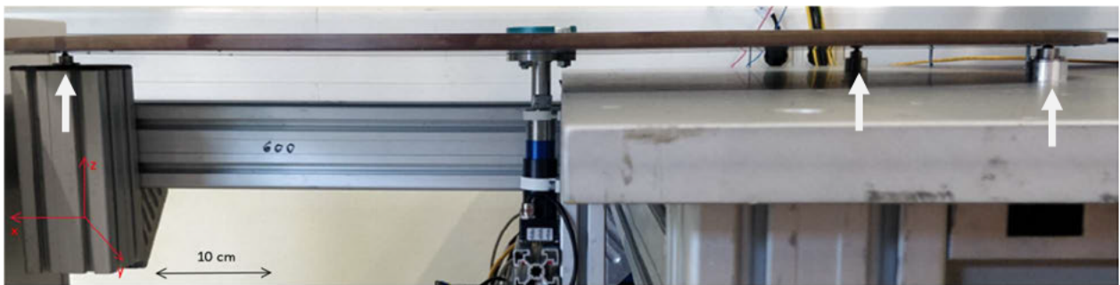
Abbildung 2.2: Abstützung der Übergabestation
