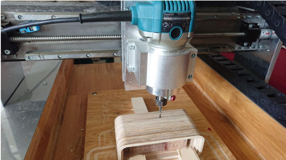
Abbildung A.7: Weitere Aufspannung des Weckers
