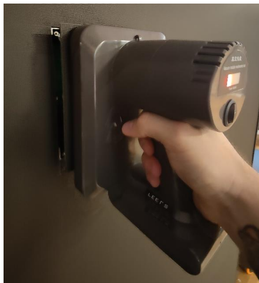
Abbildung 51: Ausbau einer IM mit Hilfe eines Vakuum Front Service Tools 91
