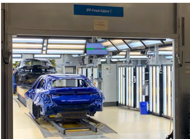
Abbildung 21: Manuelle Kabine IPP- Finish
