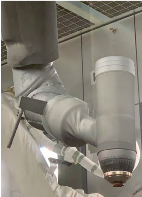
Abbildung 5: Die Glocke installiert am Roboter
