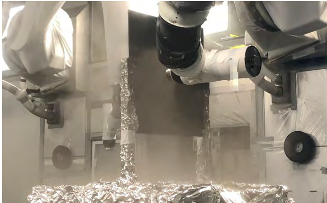
Abbildung 52: Roboter lackiert Versuchsblech mit BC1
