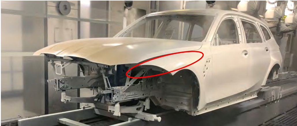
Abbildung 41: Lackierprozess ohne horizontale Flächen
