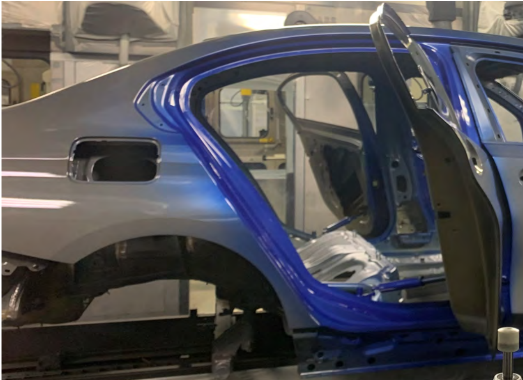
Abbildung 15: BC2-Schicht wird auf die BC1-Schicht aufgetragen
