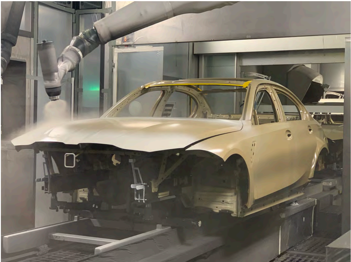
Abbildung 14: BC1-Schicht wird auf die KTL-Schicht aufgetragen
