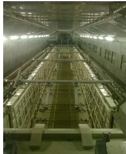
Abbildung 11: (rechts) Becken der kathodischen Tauchlackierung
