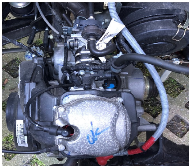
Abbildung 6: Traktionsantrieb Calessino E4 Ansicht Oben [3]
