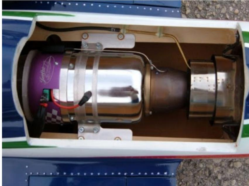
**Abbildung 2.4** Einbau eines Modellstrahltriebwerks in eine CC Aermacchi M-339. (Str)
