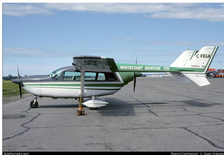
**Abbildung 2.5** Die Cessna 336 Skymaster, angetrieben durch eine Kombination aus Zug- und Druckpropeller. (Ces)
