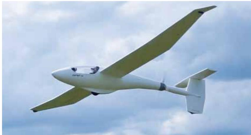
**Abbildung 1.2** Bild des elektrisch betriebenen Segelflugzeuges GFW-4. (Müller 2019)
