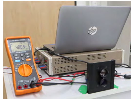
(b) Messaufbau eines Transceiver mit Multimeter, Optik, Spannungsversorgung und PC
