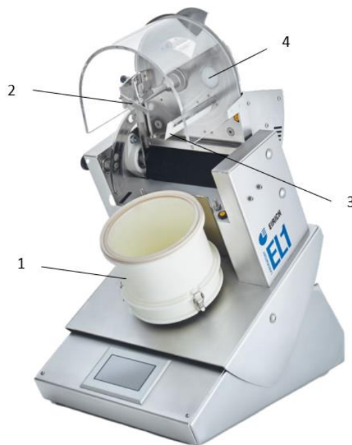
Abbildung 31: Aufbau des Eirich-Intensivmischer Typ EL1 [27]
