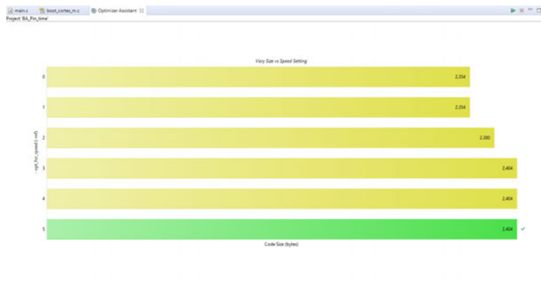
(a) Optimierungsassistent: Programmgeschwindigkeit vs. Programmgröße für Optimierungslevel Off
