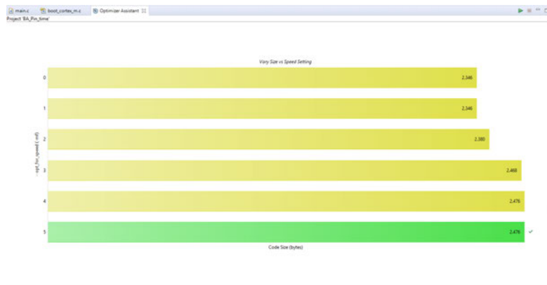
(a) Optimierungsassistent: Programmgeschwindigkeit vs. Programmgröße für Optimierungslevel 2
