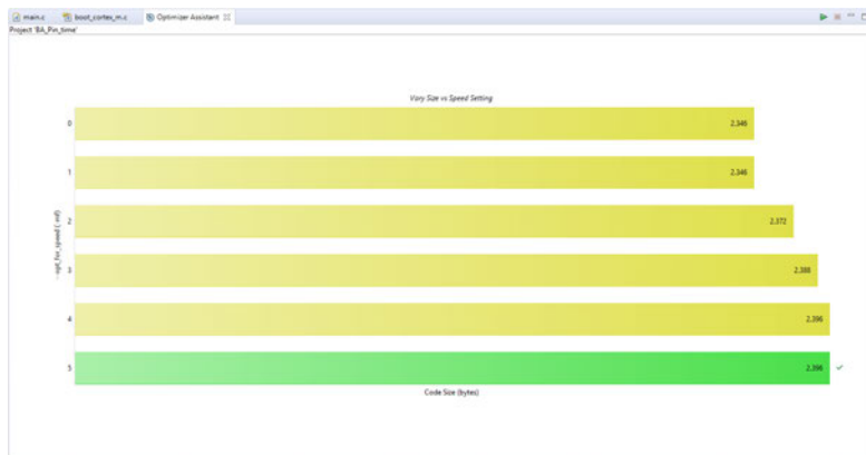
(a) Optimierungsassistent: Programmgeschwindigkeit vs. Programmgröße für Optimierungslevel 1
