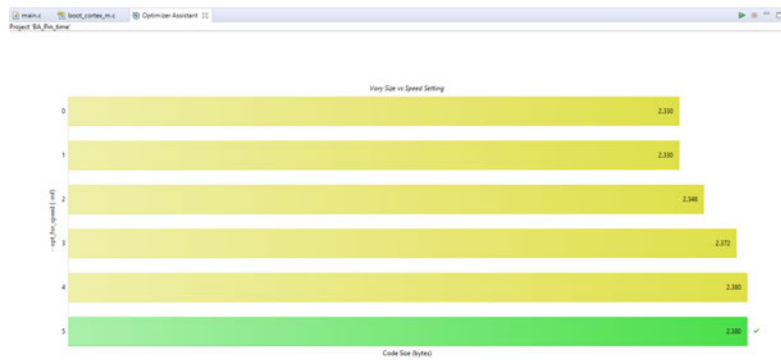
(a) Optimierungsassistent: Programmgeschwindigkeit vs. Programmgröße für Optimierungslevel 3
