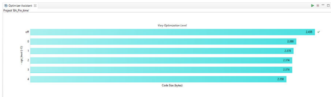
Abbildung 4.4: CCS: Beispiel Optimierungslevel vs. Code Size
