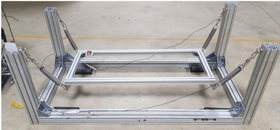
Abbildung 5.1: Testaufbau bestehend aus einem an vier Messfedern frei gelagerten Alurahmen
