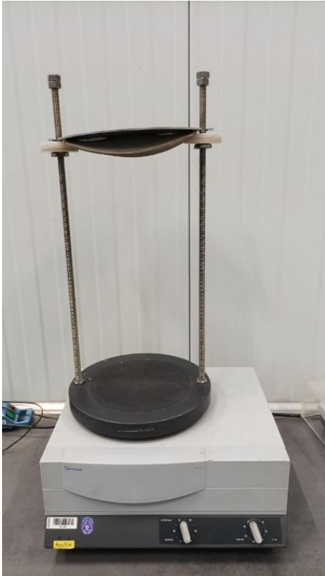
Abbildung 6: Vibrationssiebturm AS 200 basic, Tietjen
