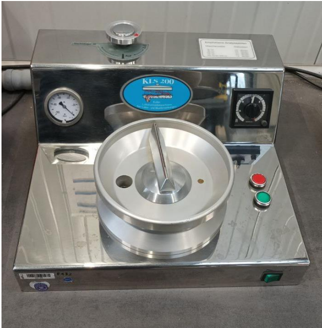
Abbildung 8: Luftstrahlsieb KLS 200, Tietjen
