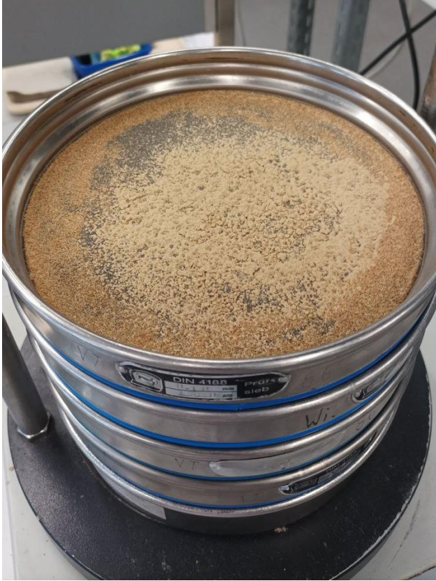
Abbildung 19: Agglomeration auf dem 180 \mu\text{m} Sieb, Siebturmanalyse
