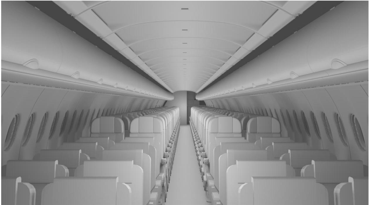
Abbildung 5.3: Auf CPACS basierender Kabinenentwurf mittels KBE, kleine Kabine, Ansicht innen
