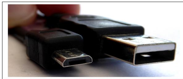
Abbildung 2.14: Micro-USB (links) und USB Typ-A
