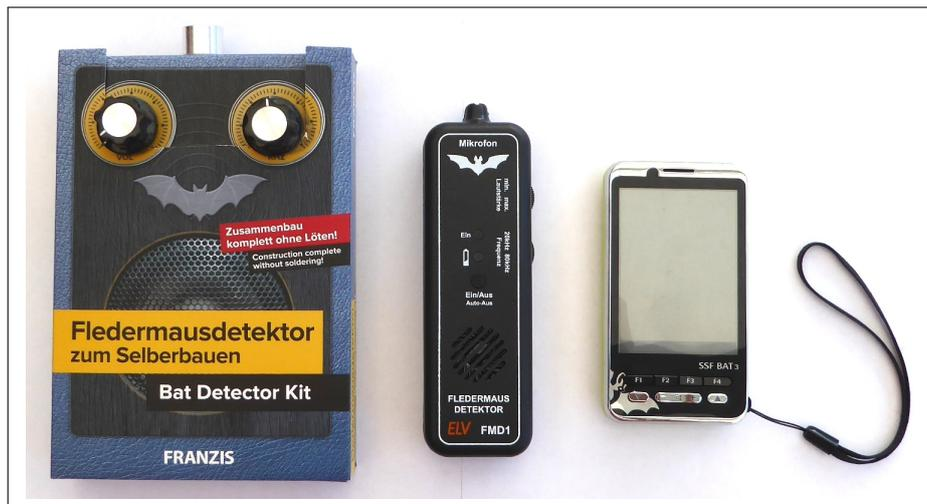
Abbildung 2.11: Fledermausdetektoren (von links): Franzis, ELV FMD1, SSF BAT 3
