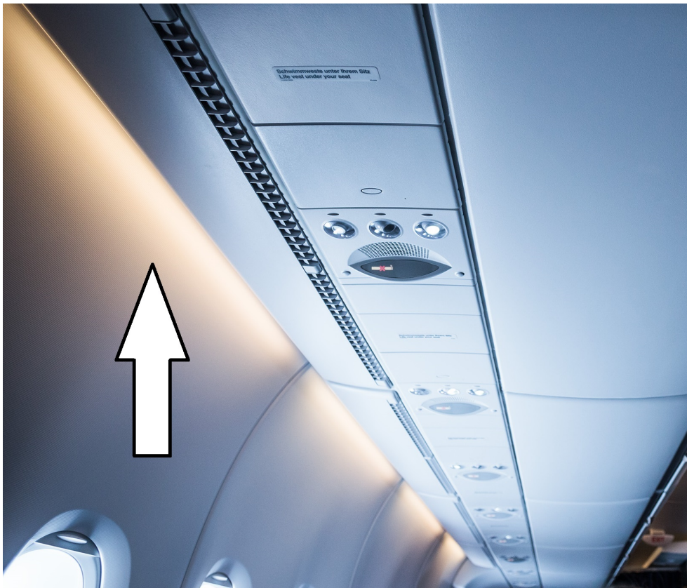
Abbildung 5.9: Kabinenbeleuchtung in der Nähe der PSU am Beispiel einer Airbus A380 Kabine [19]
