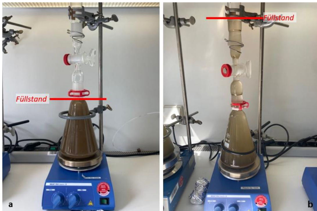
Abbildung 8: Dichteseparationseinheit gefüllt bis zum 1. (a) und 2. Füllstand (b) (Eigene Aufnahmen)
