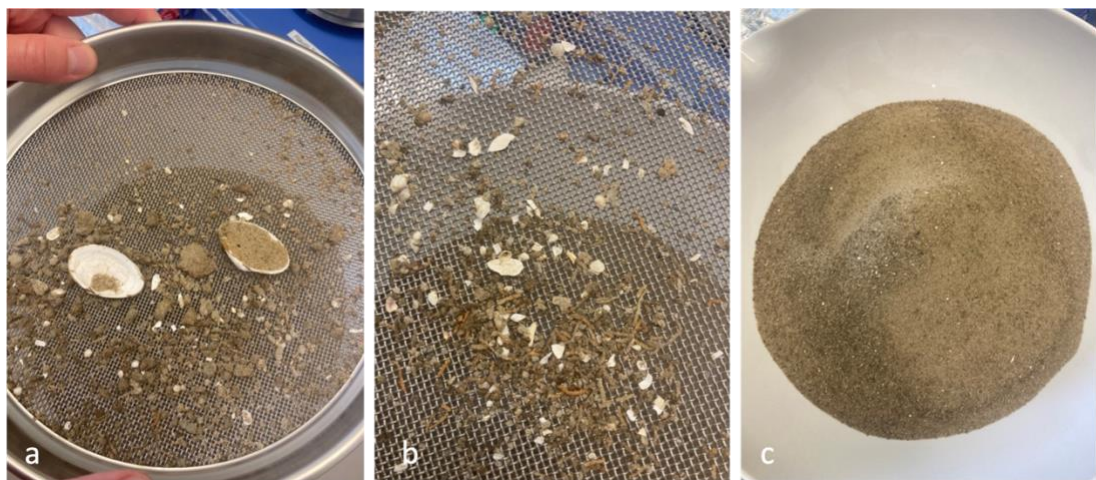
Abbildung 5: Sieben (a, b) und Homogenisierung (c) der getrockneten Sedimentprobe (Eigene Aufnahmen)
