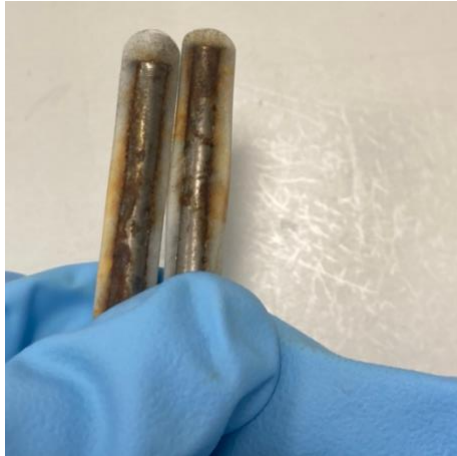
Abbildung 17: Abgenutzte Rührfischchen (Eigene Aufnahme)
