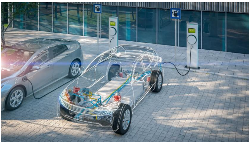
Abbildung 3: Aufbau Elektrofahrzeug mit Hochvoltbatterie im Fahrzeugboden 15
