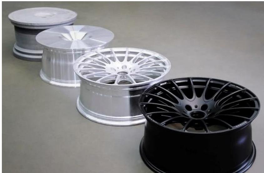
Abbildung 3.3 Entstehung eines Schmiederads (**felgenabc o.J.**)
