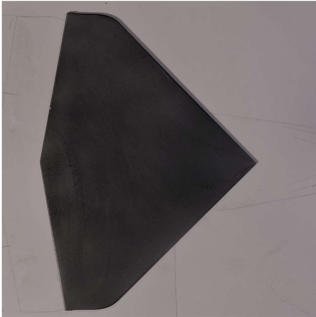
Abbildung 94: Anstrichbild, Deltaflügel großer Streckung, \alpha=24^\circ
