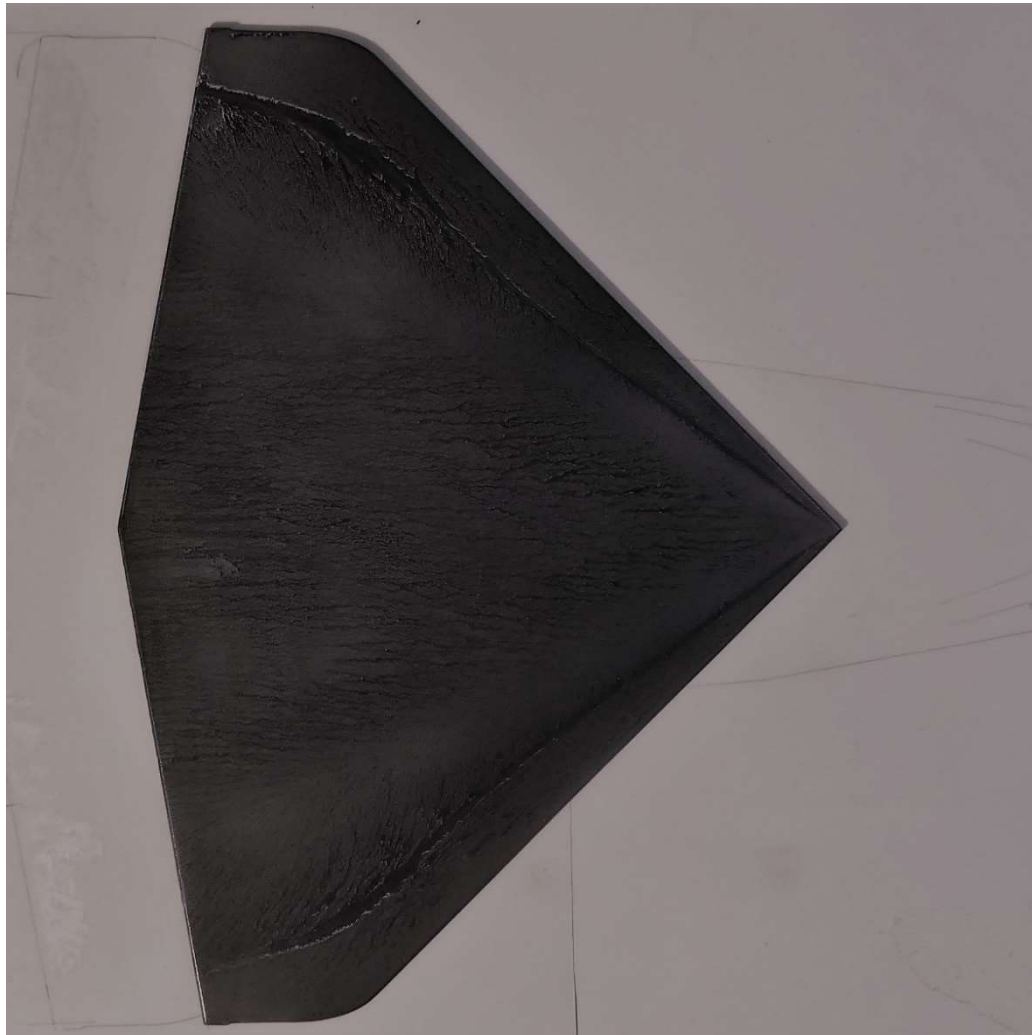
Abbildung 91: Anstrichbild, Deltaflügel großer Streckung, \alpha=8^\circ
