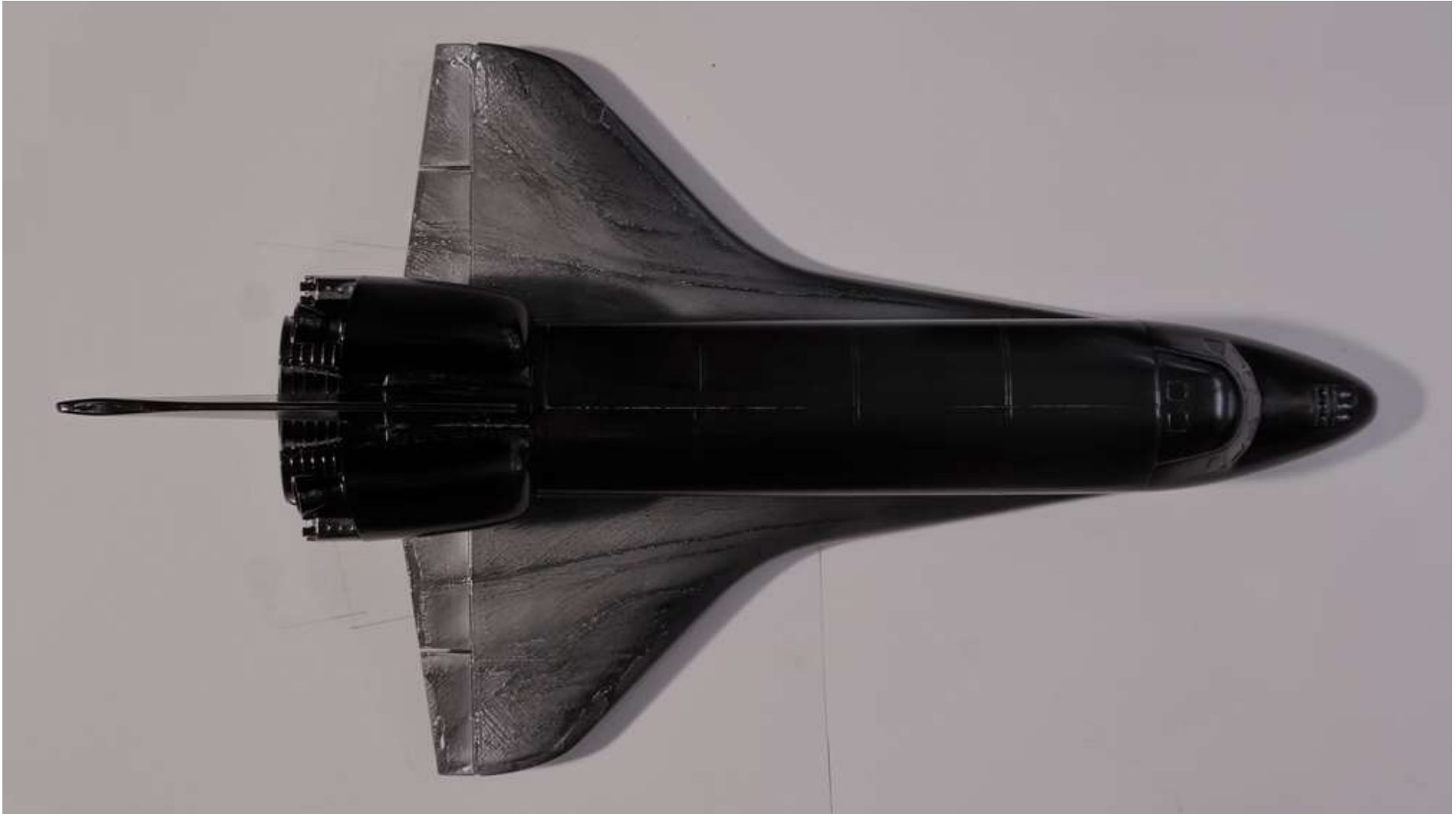
Abbildung 96: Anstrichbild, Space Shuttle, \alpha=14^\circ
