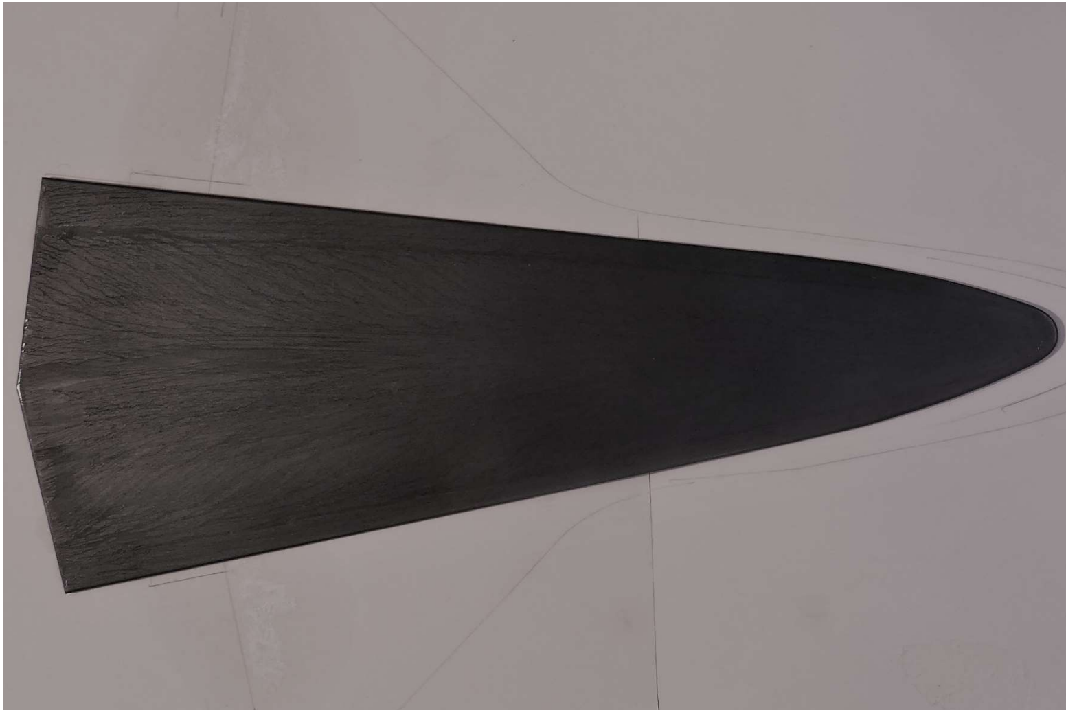
Abbildung 87: Anstrichbild, Deltaflügel kleiner Streckung, \alpha=18^\circ
