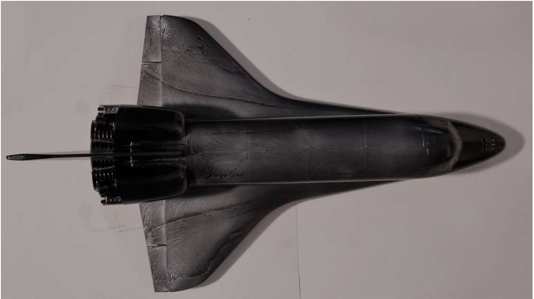
Abbildung 98: Anstrichbild, Space Shuttle, \alpha=24^\circ
