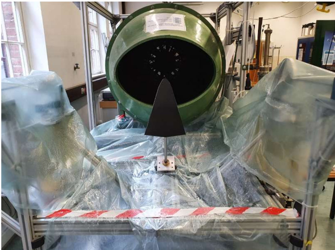
Abbildung 23: Versuchsaufbau zur Anfertigung der Anstrichbilder
