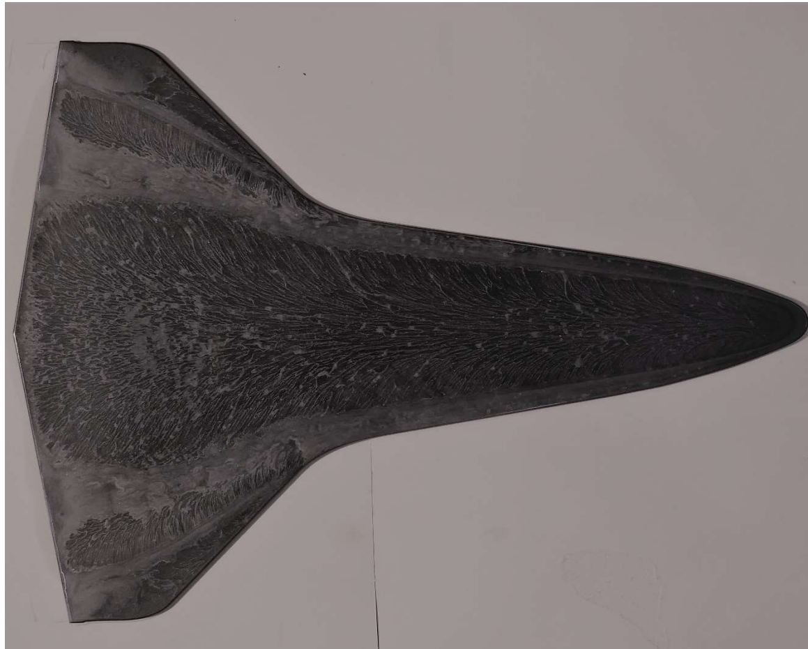
Abbildung 83: Anstrichbild, Doppeldeltaflügel, \alpha = 18^\circ
