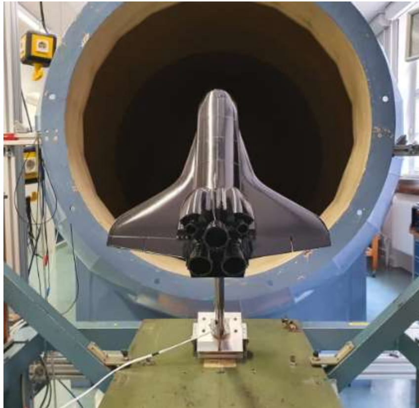
Abbildung 31: Space Shuttle Modell im großen Windkanal
