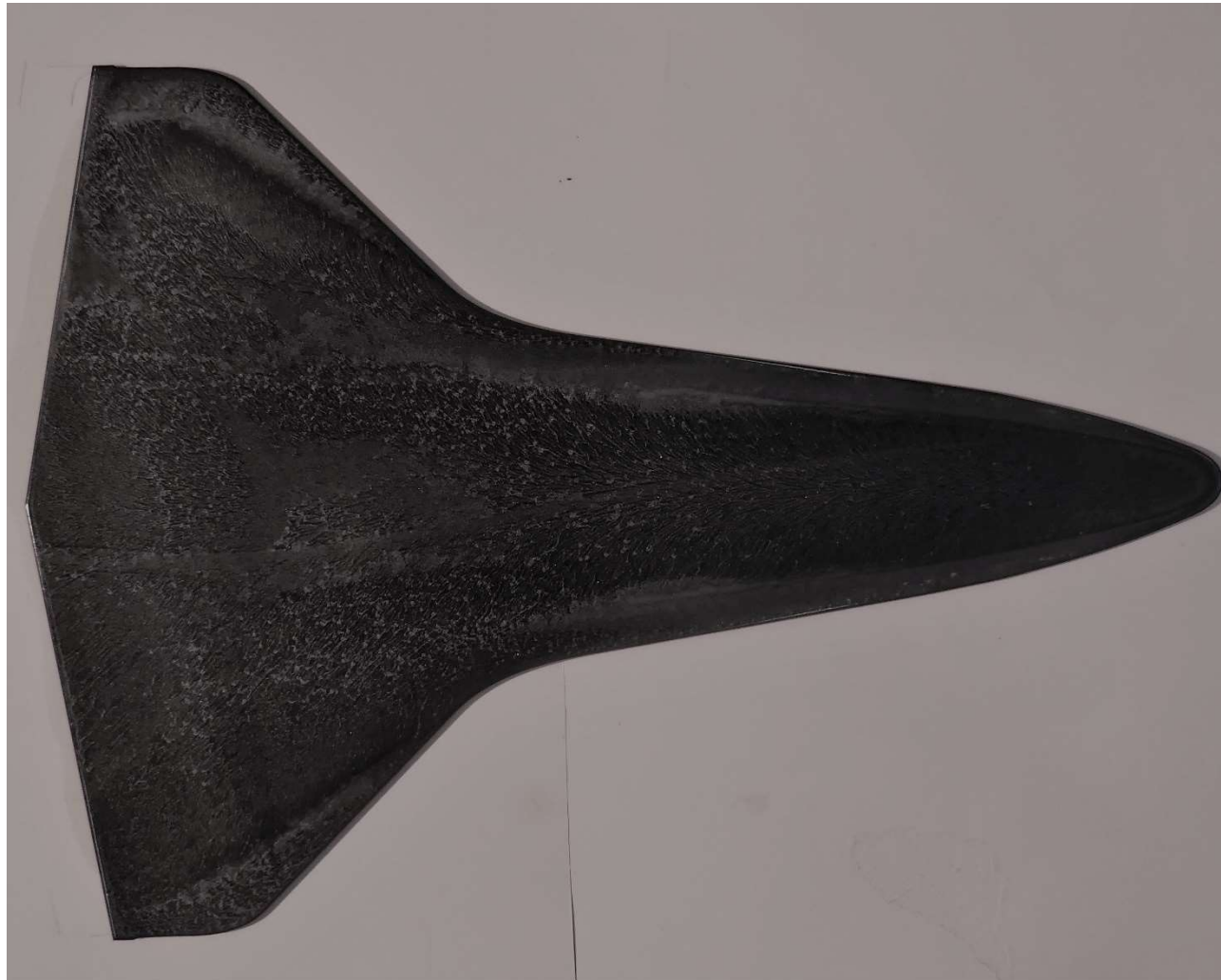
Abbildung 86: Anstrichbild, Doppeldeltaflügel, \alpha=40^\circ
