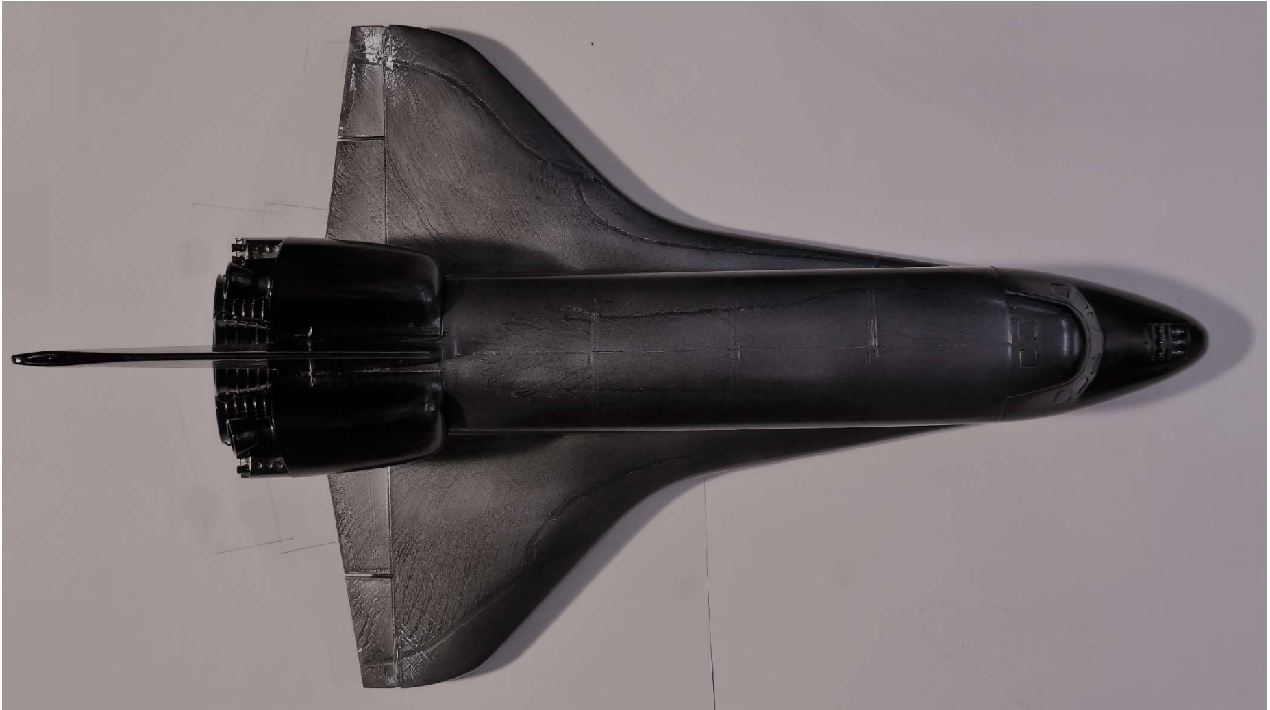
Abbildung 99: Anstrichbild, Space Shuttle, \alpha=34^\circ
