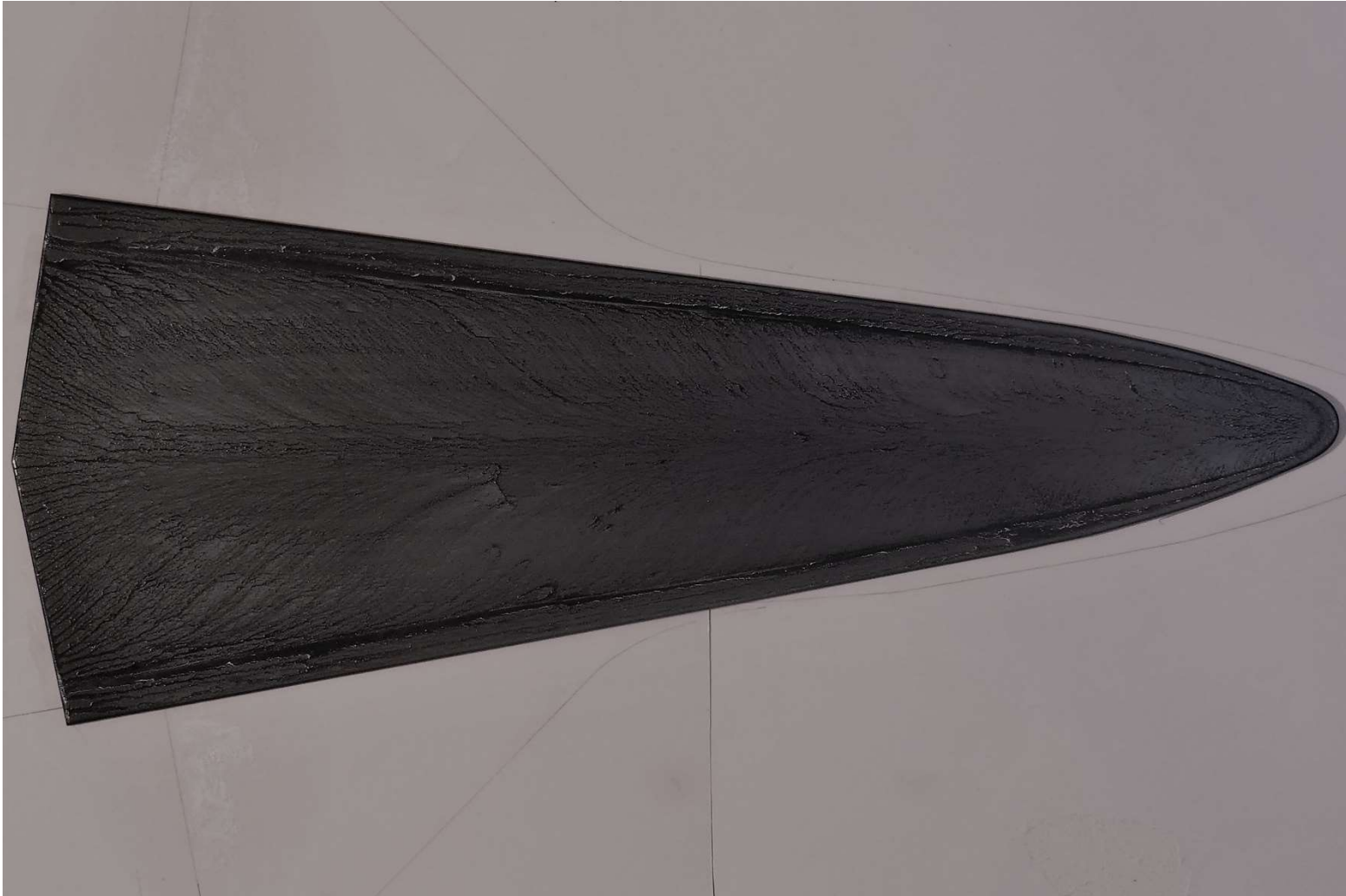
Abbildung 88: Anstrichbild, Deltaflügel kleiner Streckung, \alpha=28^\circ
