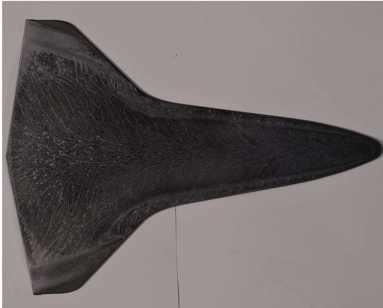
Abbildung 85: Anstrichbild, Doppeldeltaflügel, \alpha=28^\circ
