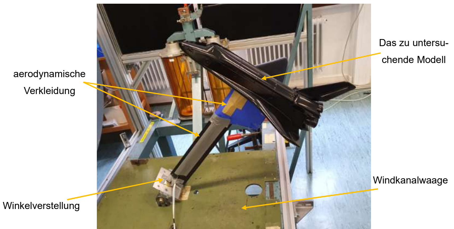
Abbildung 22: Versuchsaufbau zur Messung der Luftkräfte
