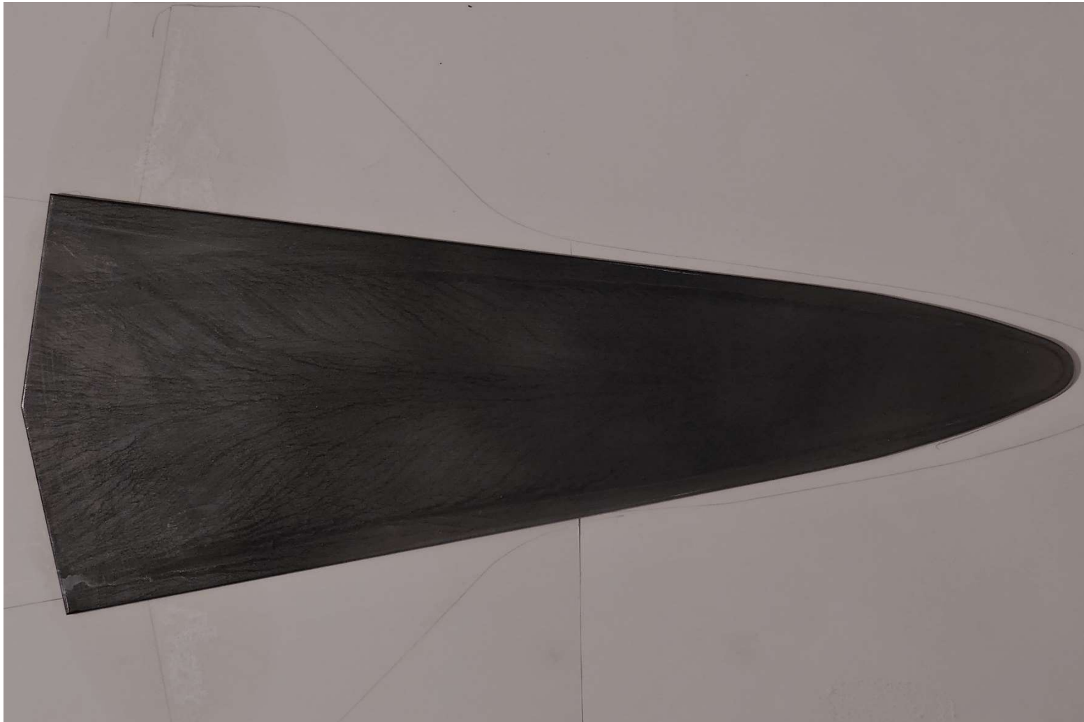
Abbildung 89: Anstrichbild, Deltaflügel kleiner Streckung, \alpha=40^\circ
