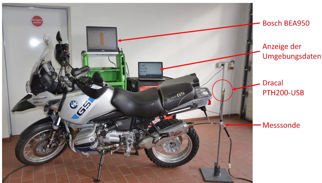
Abbildung 11: Versuchsaufbau der Messreihen zur CO-Endrohrmessung bei Krafträdern
