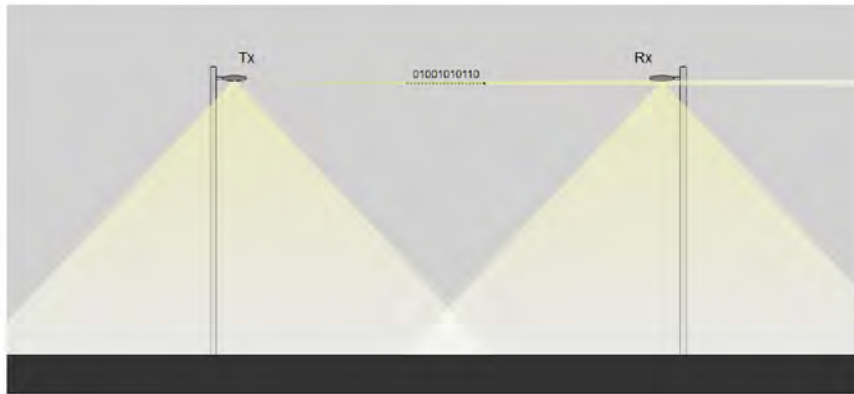
Abbildung 5.1: Veranschaulichung der Datenkommunikation zweier Außenbereichsleuchten, deren Lichtkegel auf den Boden gerichtet ist.[56]
