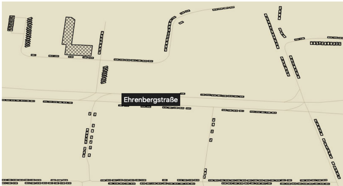
Abbildung 5.3: Parkraumlayer (Ausschnitt Ehrenbergstraße) mit Einzelparkplätzen (parallel zur Straße) und Parkfläche mit Kapazität für mehrere Fahrzeuge
