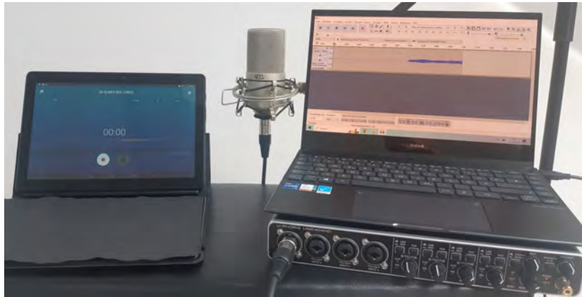
Abbildung 3.10: Versuchsaufbau Tablet, Kondensatormikrofon mit Audiointerface und Laptop
