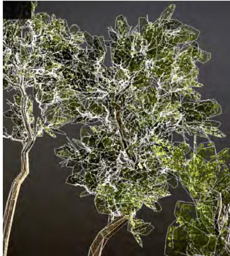
Abbildung 2.10: Photogrammetrie Probleme bei dünnen Objekten (et al., 2022)
