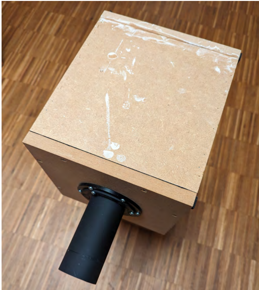
Abbildung 2.1: Testgehäuse mit montiertem Bassreflexrohr
