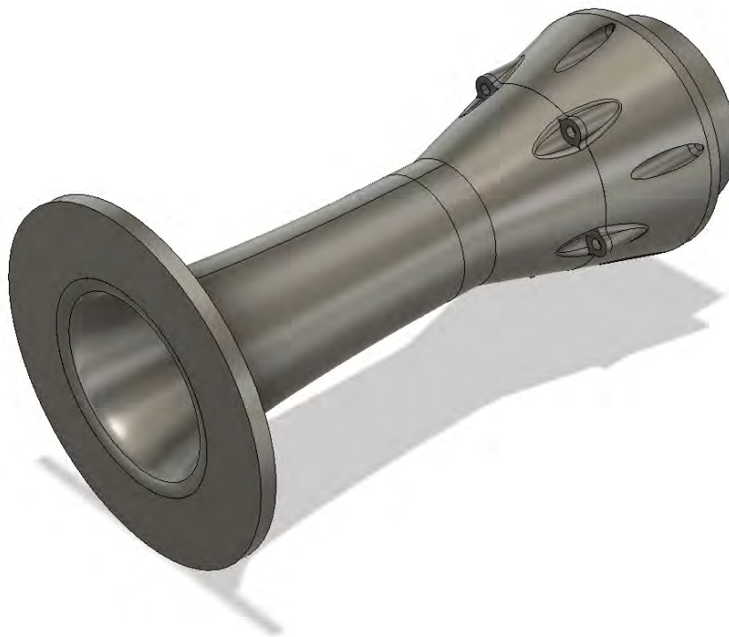
Abbildung 4.2: 3D Modell des Bassreflexrohres ohne Absorber
