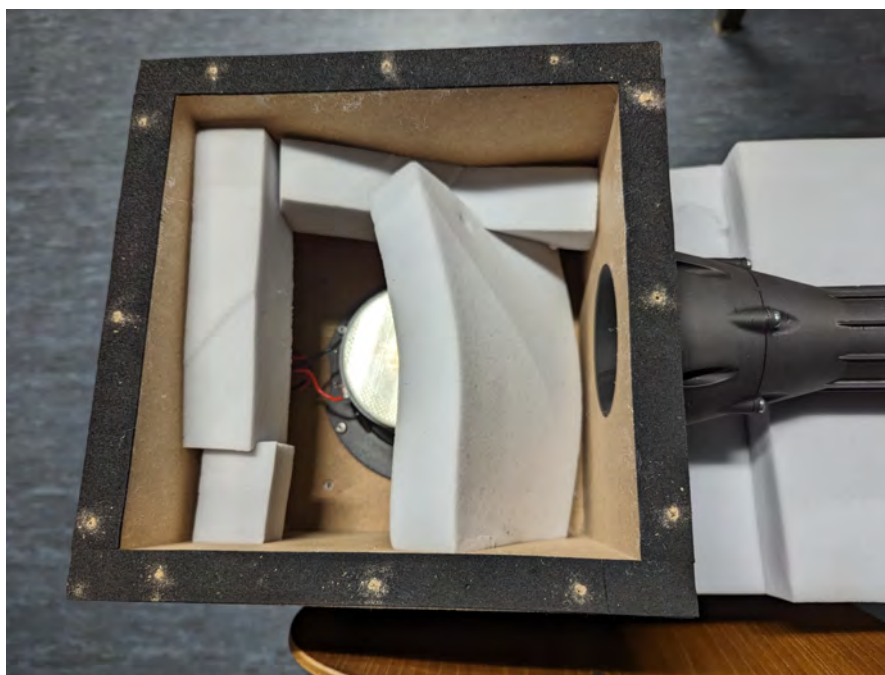
Abbildung 5.2: Akustikschaumstoff im Lautsprecher
