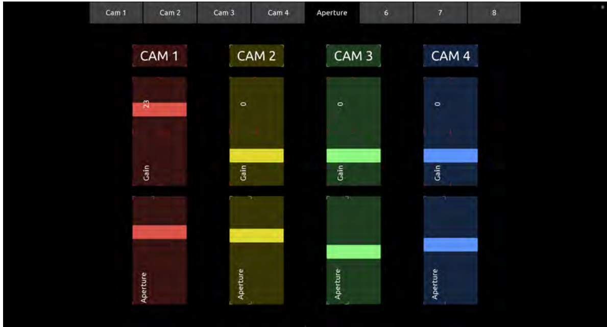
Abbildung 4.11: Layout der zweiten zur Steuerung der Kameraparameter entwickelten Kontrolloberfläche in TouchOSC
