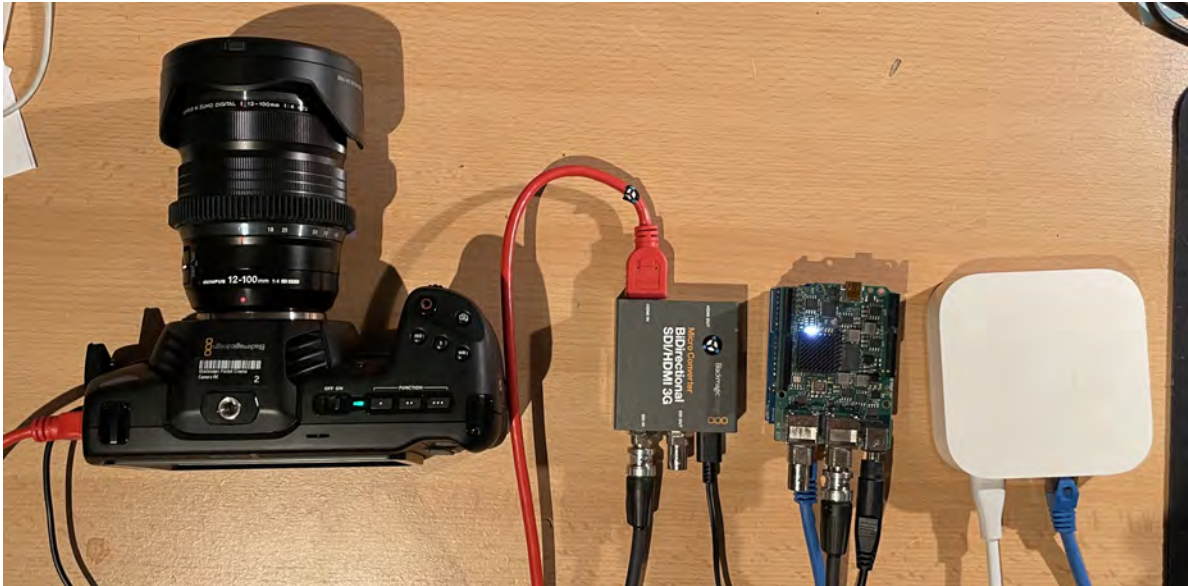
Abbildung 4.4: Testaufbau für die Softwareentwicklung
