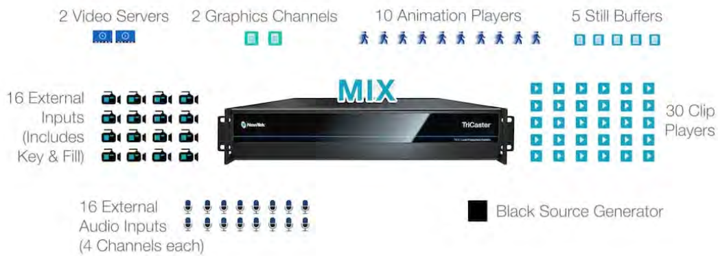
Abbildung 2.1: Schaubild aller Quellen des TriCaster TC1 von NewTek.
