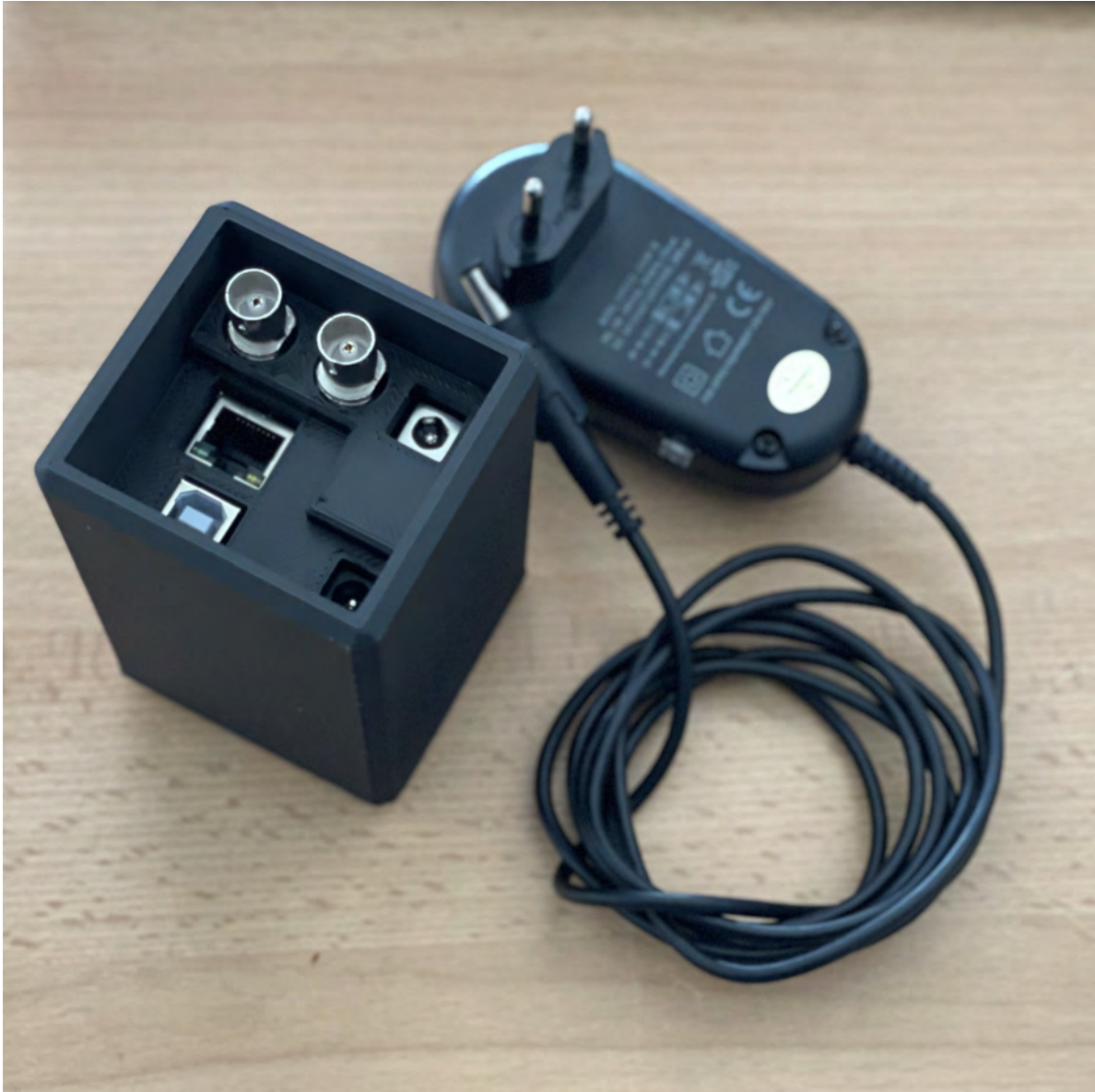
Abbildung 4.18: Kameracontroller im fertigen Gehäuse
