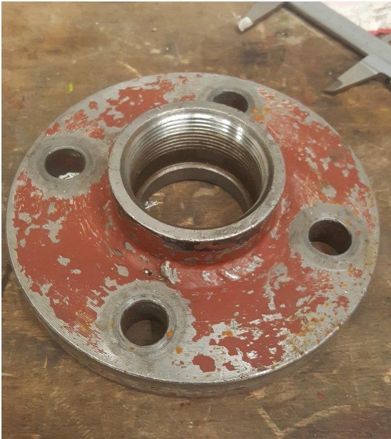
Abbildung 3 TDW-Flansch R100 zu NTP 2"
