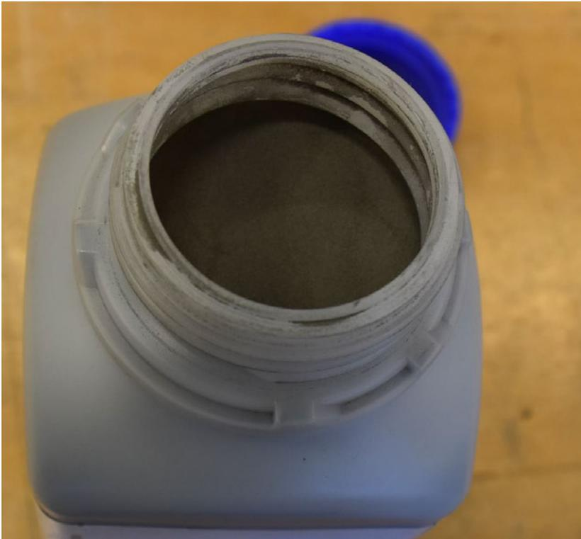
**Abbildung 16:** Das verwendete Nickel-Titan-Pulver im Aufbewahrungsbehälter.
