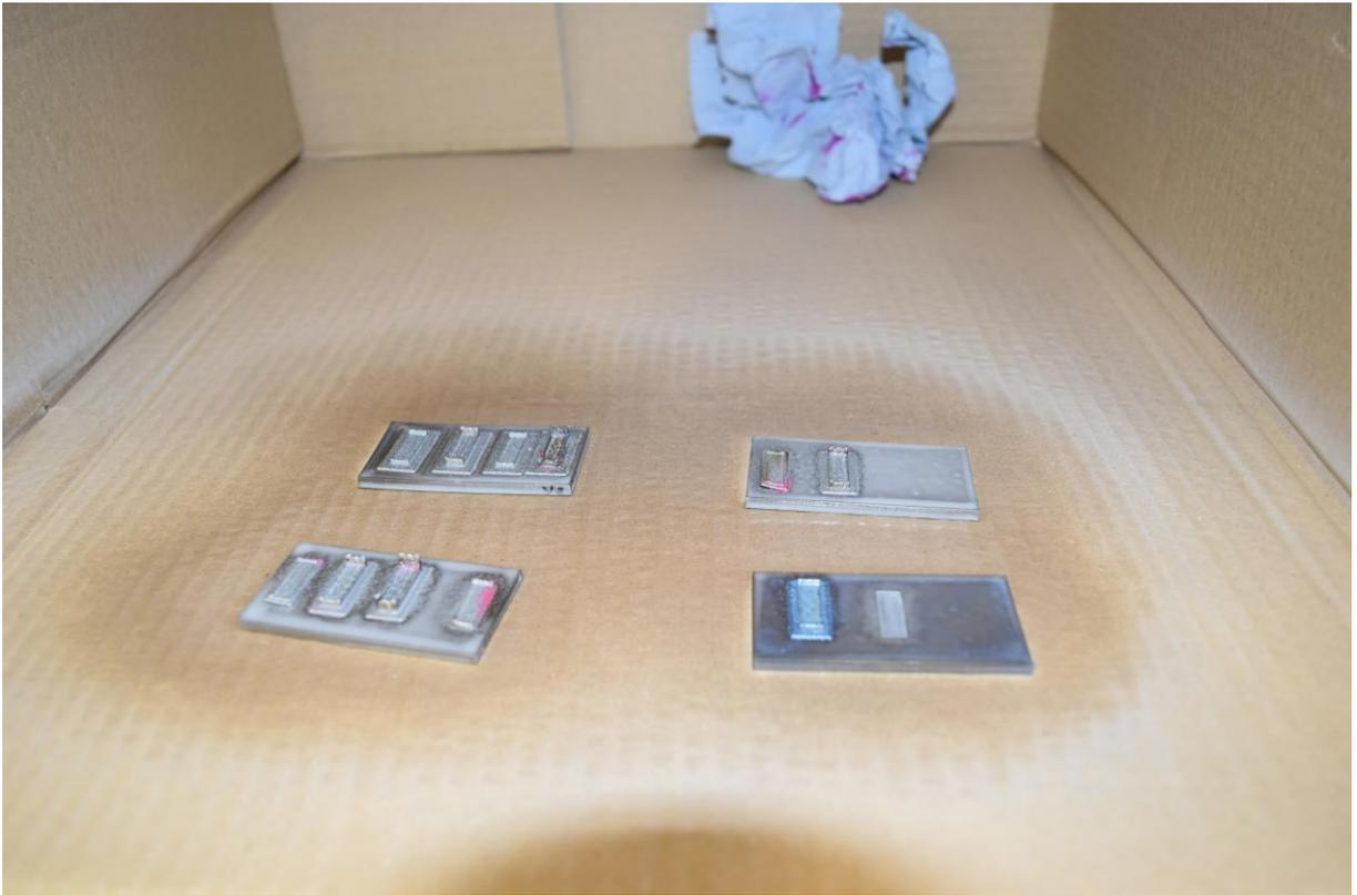
**Abbildung 63:** Die Entwicklerflüssigkeit verfärbt sich ins milchig-weiße während des Trocknens.
