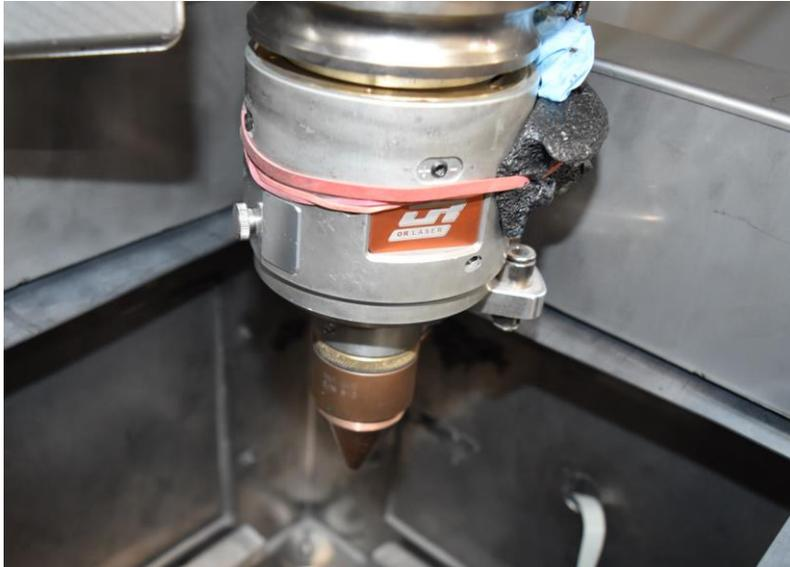
**Abbildung 38: Der Schweißkopf innerhalb der Prozesskammer.**
