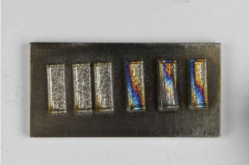
Abbildung 74: Die Platte 104.3 dargestellt in der Draufsicht. Von links nach rechts: Vergleichsprobe nach Standardparametersatz, 2 Vorbelichtungen, 4 Vorbelichtungen, 6 Vorbelichtungen, 8 Vorbelichtungen und 10 Vorbelichtungen.
