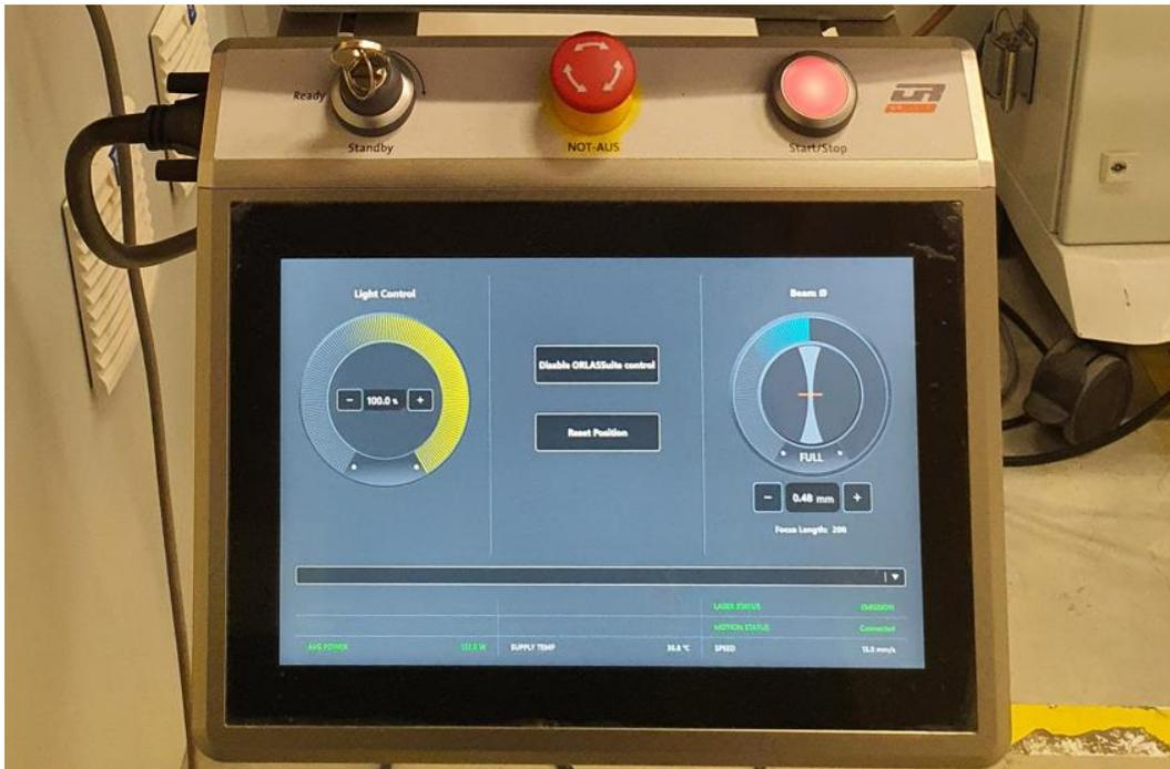
Abbildung 13: In der Abbildung ist das sekundäre Bedienelement für den Laserparameter Laserfokus zu sehen. Durch Drehbewegungen wird der Laserdurchmesser eingestellt.
