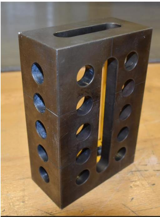
**Abbildung 53: Stahlblock zur Erhöhung der Gesamtmasse sowie zur Aufnahme der Substrat-Platte.**
