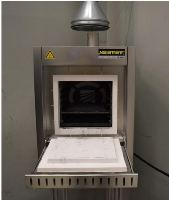
Abbildung 40: Veraschungssofen der Firma Nabertherm.
