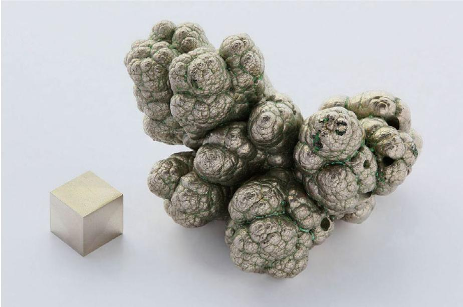
**Abbildung 14:** Nickel als Kubus (links) und in Knollenform (rechts). Die Knollenform wurde hergestellt durch Elektrolyse. [PNIOK]
