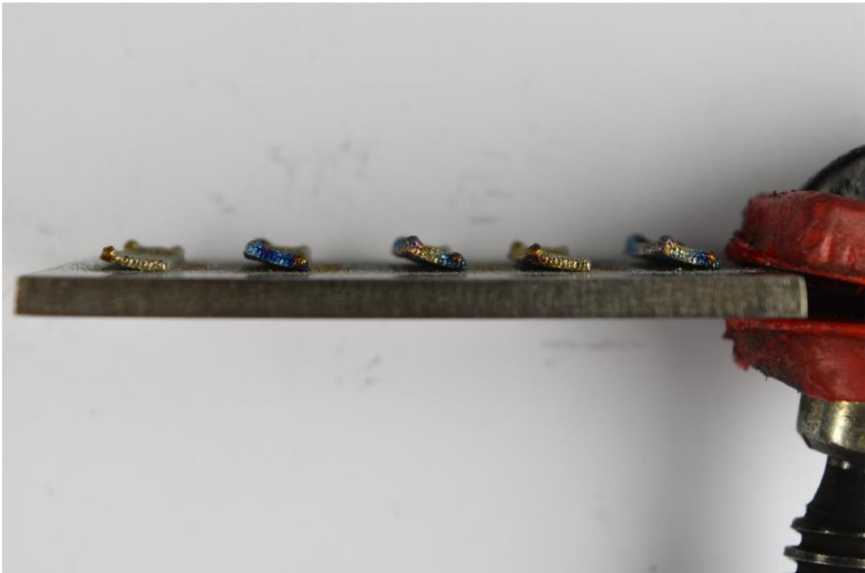
Abbildung 80: Die Platte 104.2 in der Seitenansicht. Die zweite Probe von rechts wurde mit einem fremden Parametersatz geschweißt und ist deshalb nicht weiter zu beachten. Es können deutliche Delaminationen festgestellt werden.
