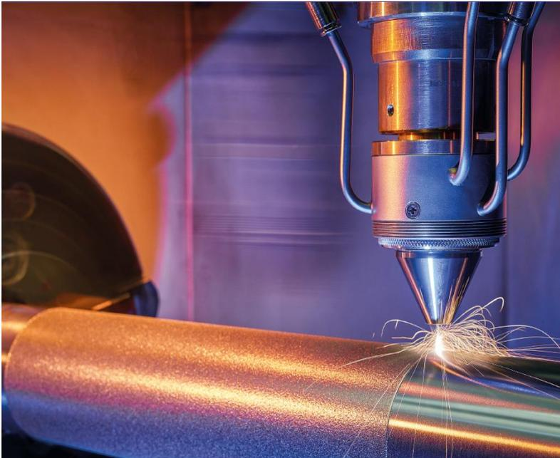
**Abbildung 4: Erzeugung einer umlaufenden Beschichtung auf einer sich drehenden Welle. [HÄFNER]**
