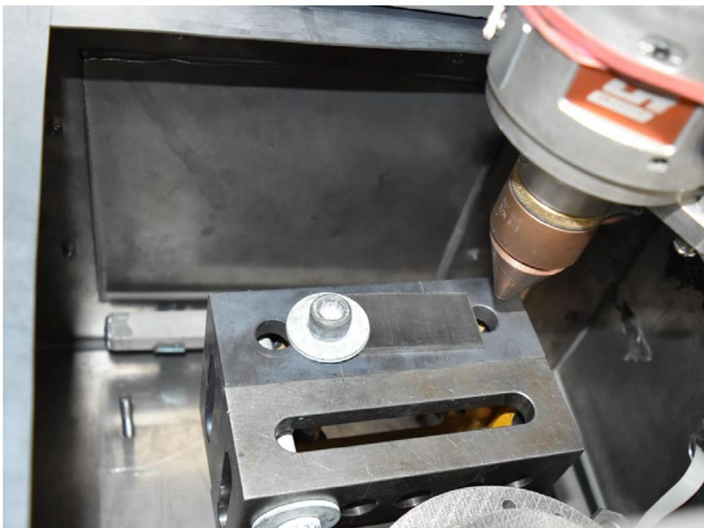
**Abbildung 59:** Die Abbildung zeigt die Ausgangssituation in der Schutzgaskammer vor Beginn des Schweißvorgangs.
