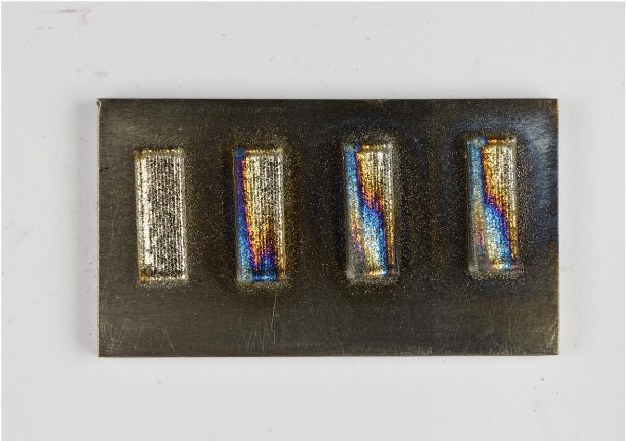
**Abbildung 79:** Es sind deutliche Verfärbungen auf der Platte 104.2 zu erkennen. Von links nach rechts: Probe 104.2.1/.2/.3/.4.
