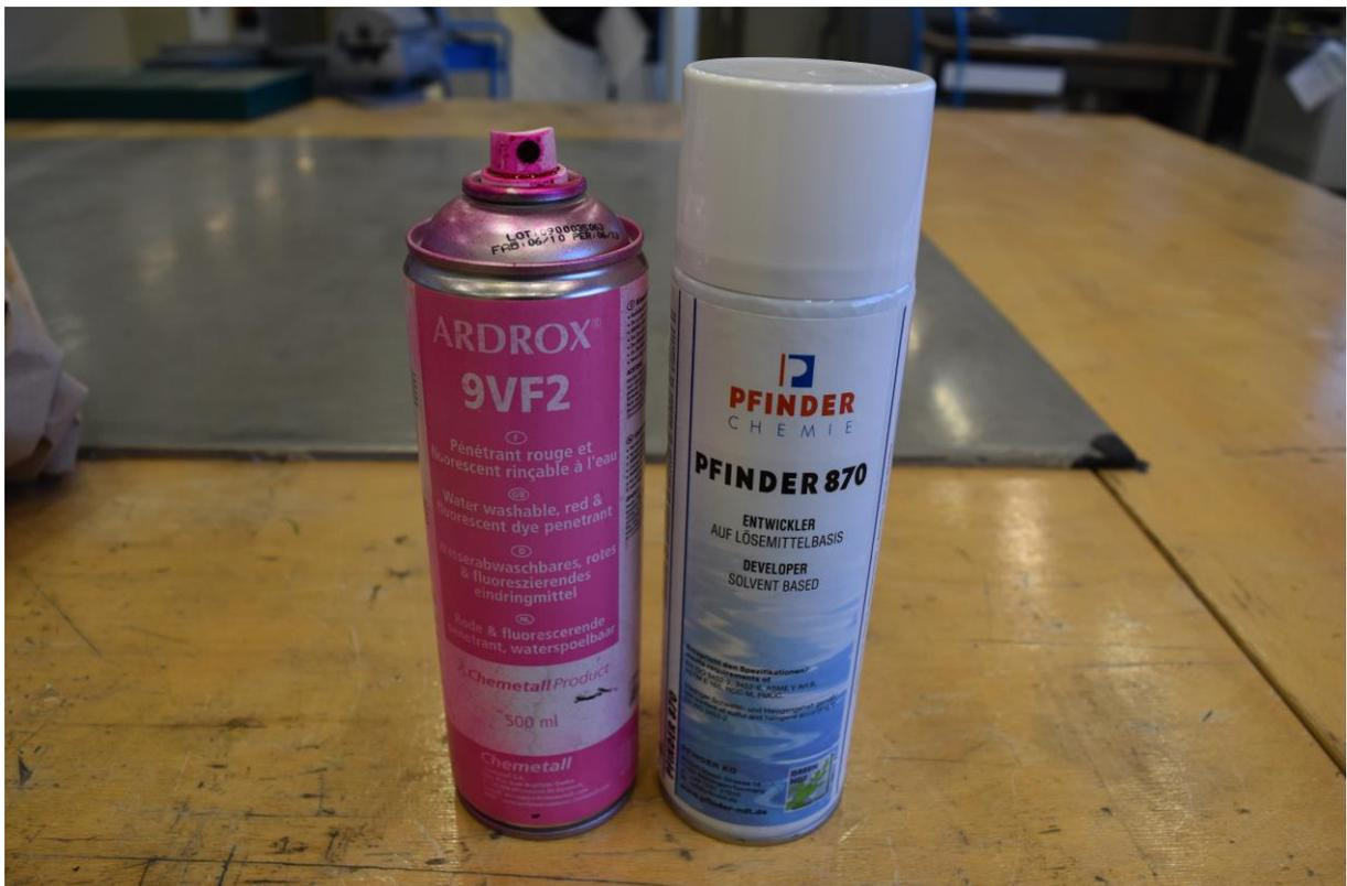
Abbildung 60: Zu sehen ist links das Farbeindringmittel und rechts die Entwicklerflüssigkeit.
