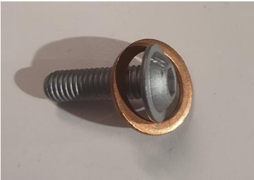
**Abbildung 18: Ölablassschraube mit Kupferdichtung in Ringform.**
