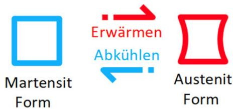
**Abbildung 30:** Die Abbildung zeigt einen blauen Klotz aus Martensit. Durch Erwärmen bildet sich die austenitische Form wie zuvor beim Einweg-Effekt. Im Unterschied zum Einweg-Effekt kann man zusätzlich die Umformung beim Abkühlen in eine festgelegte, martensitische Form beobachten.
