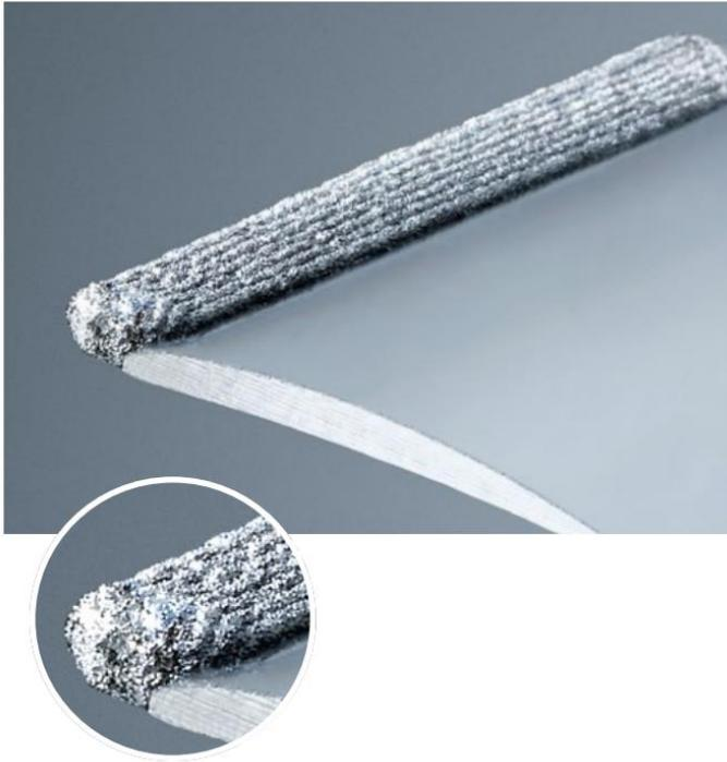
**Abbildung 5: Wiederhergestellte Vorderkante einer Turbinenschaufel mithilfe des Laser-Pulver-Auftragsschweißens. [TRUMPF]**
