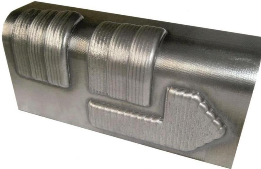
**Abbildung 6: Lokale Materialverstärkungen gegen das Ausbeulen eines Bauteils. [KLB]**
