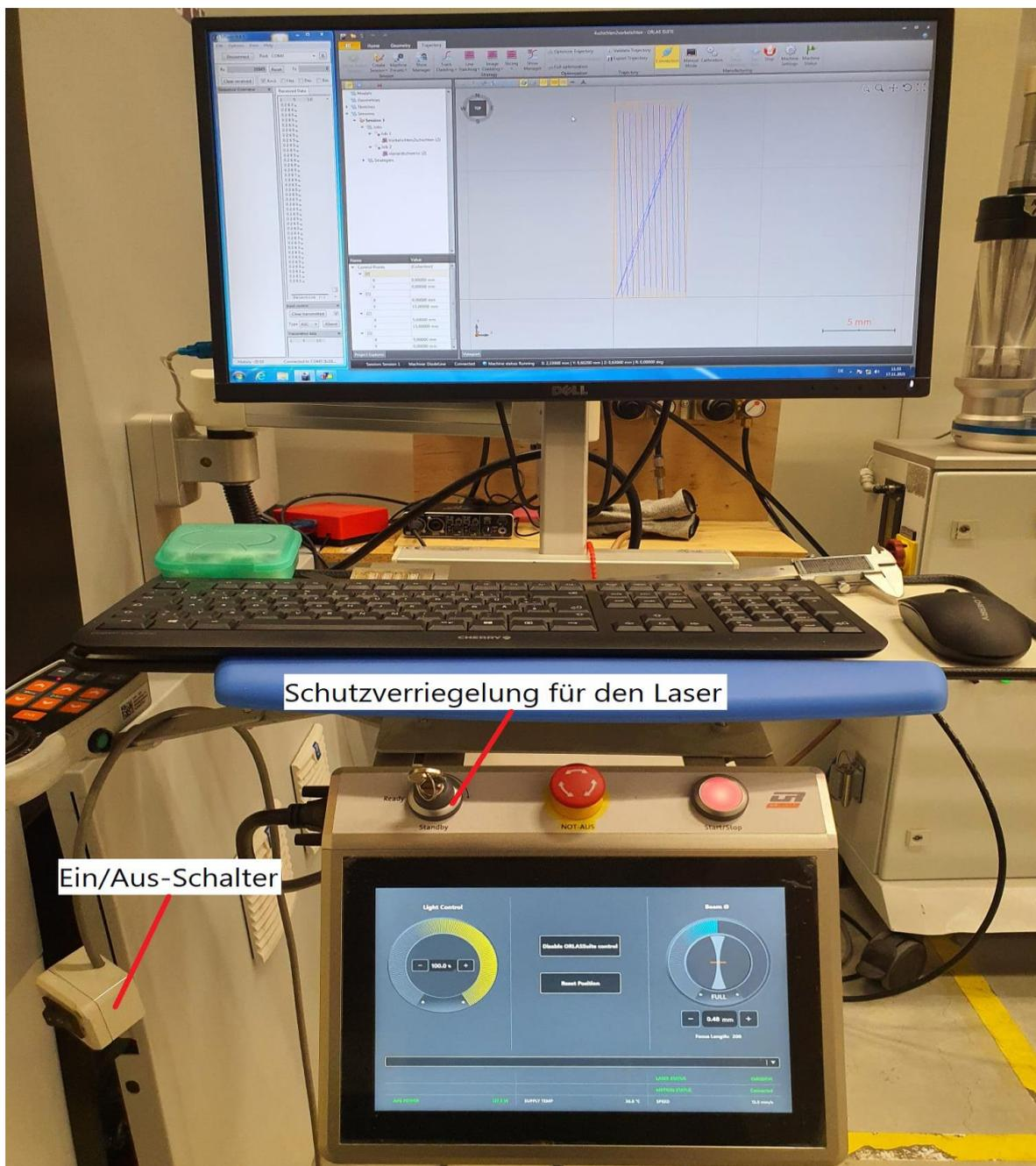
Abbildung 55: Zu erkennen sind sicherheitsrelevante Bedienelemente.
