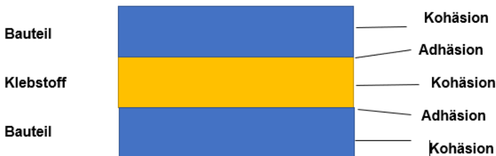
Abbildung 17/ Adhäsions- und Kohäsionskräfte einer Klebeverbindung (Dr. Wolfgang Fleischmann juni/2010)
