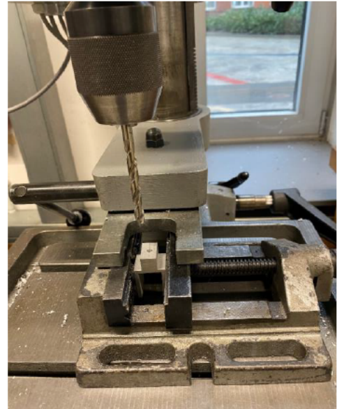
Abbildung 42/ Kernlochbohrung in der ZLW (HAW)
